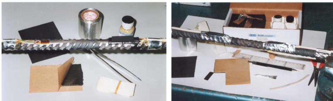
*Figura 6.9 – Protección de las galgas en armaduras*
