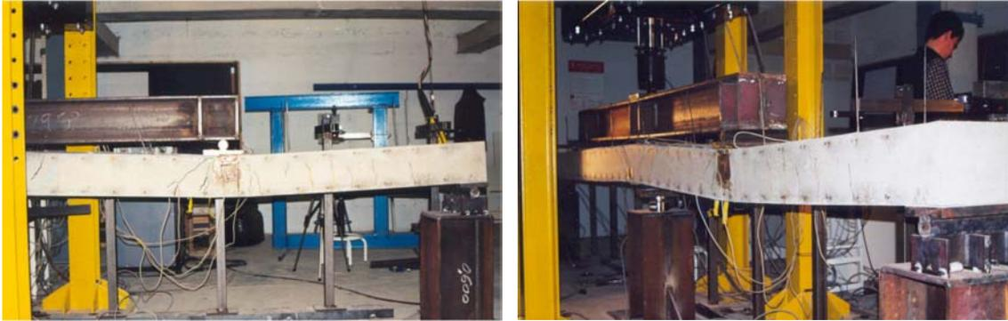
*Figura 6.25 – Instantes anteriores al colapso: (a) Segundo vano; (b) perspectiva*
