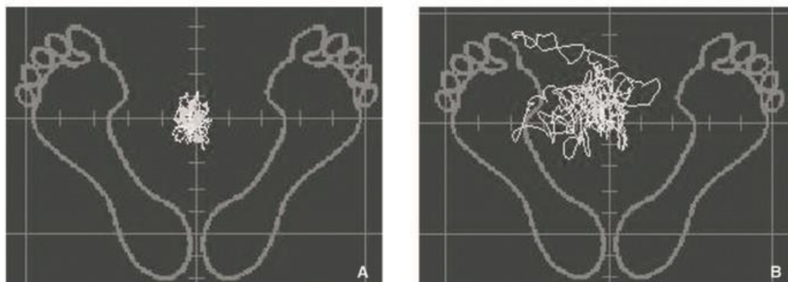
Figura 22. Registro de la oscilación postural con plataforma dinamométrica. Resultado del test en sujeto sin alteración (A) y sujeto con problemas de equilibrio (B) (Peydro et al., 2005).
