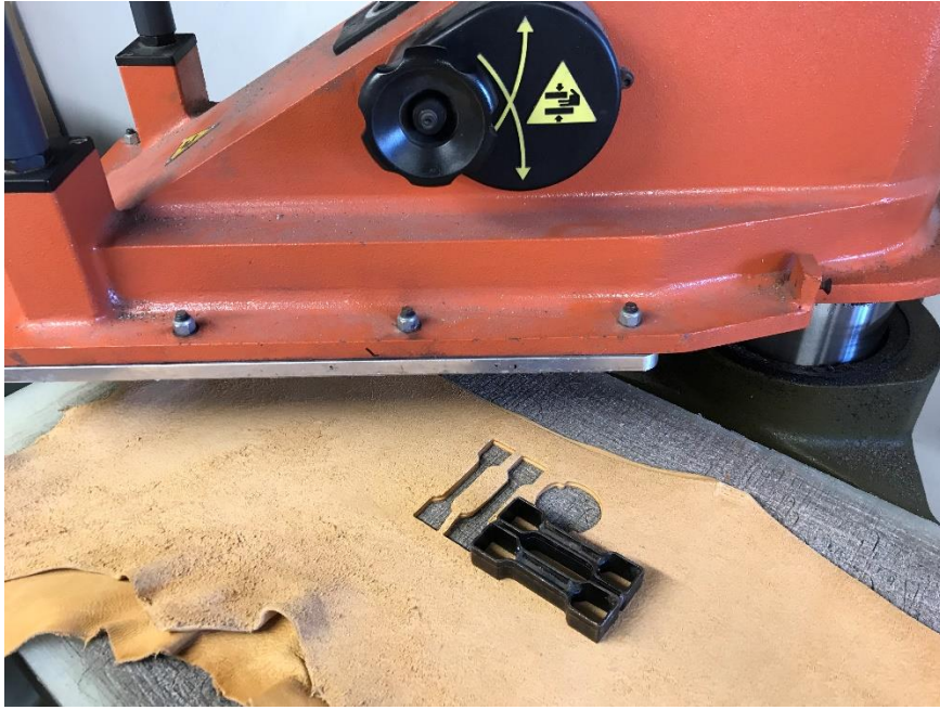
Figura 58. Troqueladora utilitzada per tallar les provetes en la posició oficial de mostreig del cuir.
