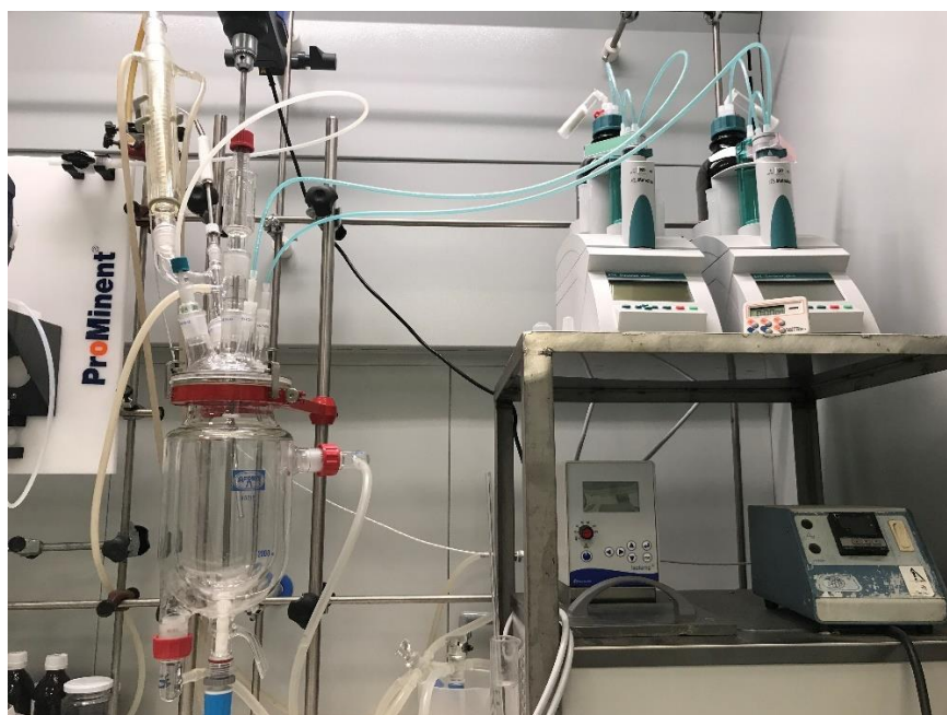
Figura 65. Reactor de laboratori i muntatge utilitzat per realitzar les síntesis dels productes finals a provar en els tests de readobatge.
