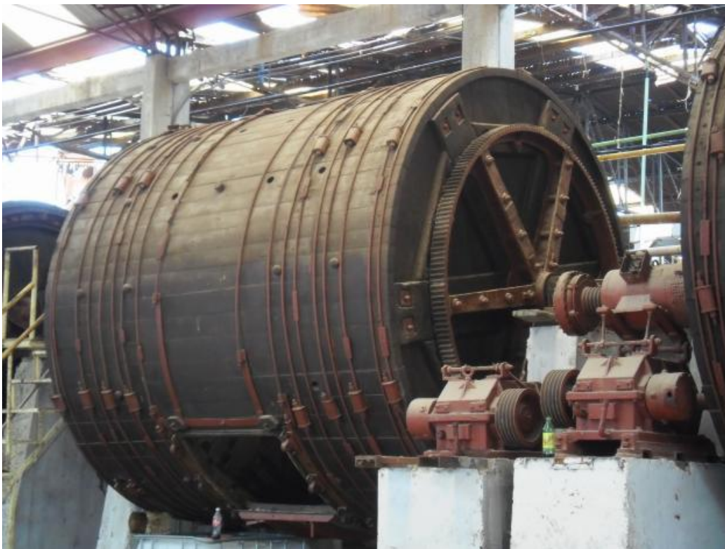
Figura 6.4.2: Tambor típico donde se lleva a cabo la etapa Ribera en el proceso de curtido del cuero
