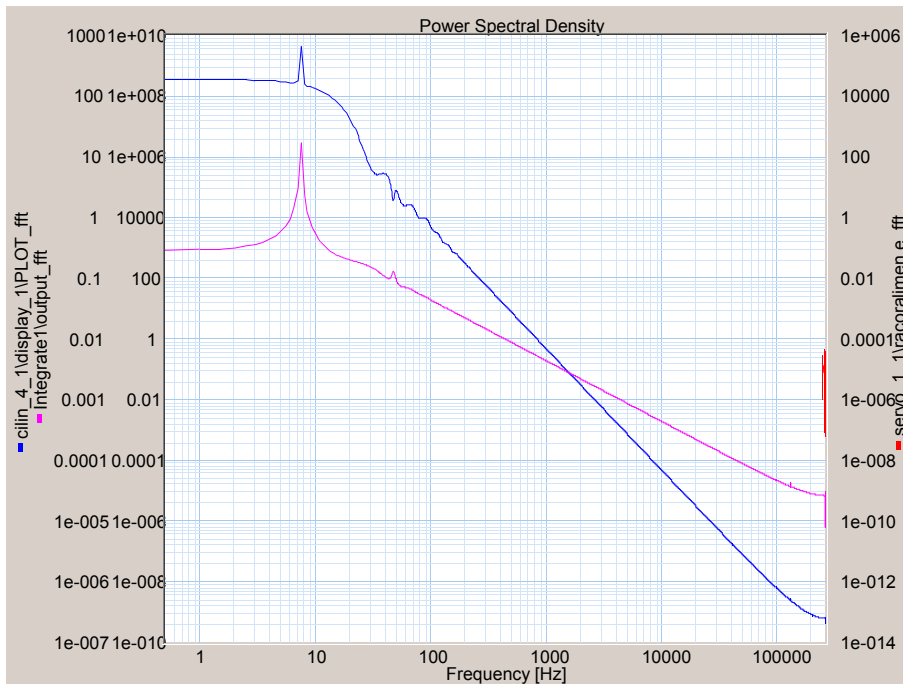
Gráfica 4.66 Respuesta frecuencial con R_{fugas}=30
