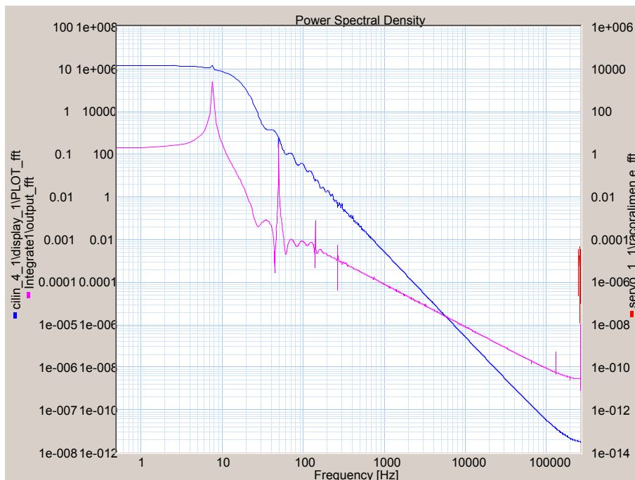
Gráfica 4.34 Respuesta frecuencial con cuadruple área pistón Azul posición cilindro ( W \overline{W} / f ) (10^{-8} \div 10^2 \text{ cm}^2/\text{Hz}) Magenta posición extremo viga ( W \overline{W} / f ) (10^{-12} \div 10^8 \text{ cm}^2/\text{Hz})
