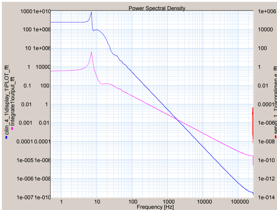
Gráfica 4.50 Respuesta frecuencial con conjunto servoactuador doble
