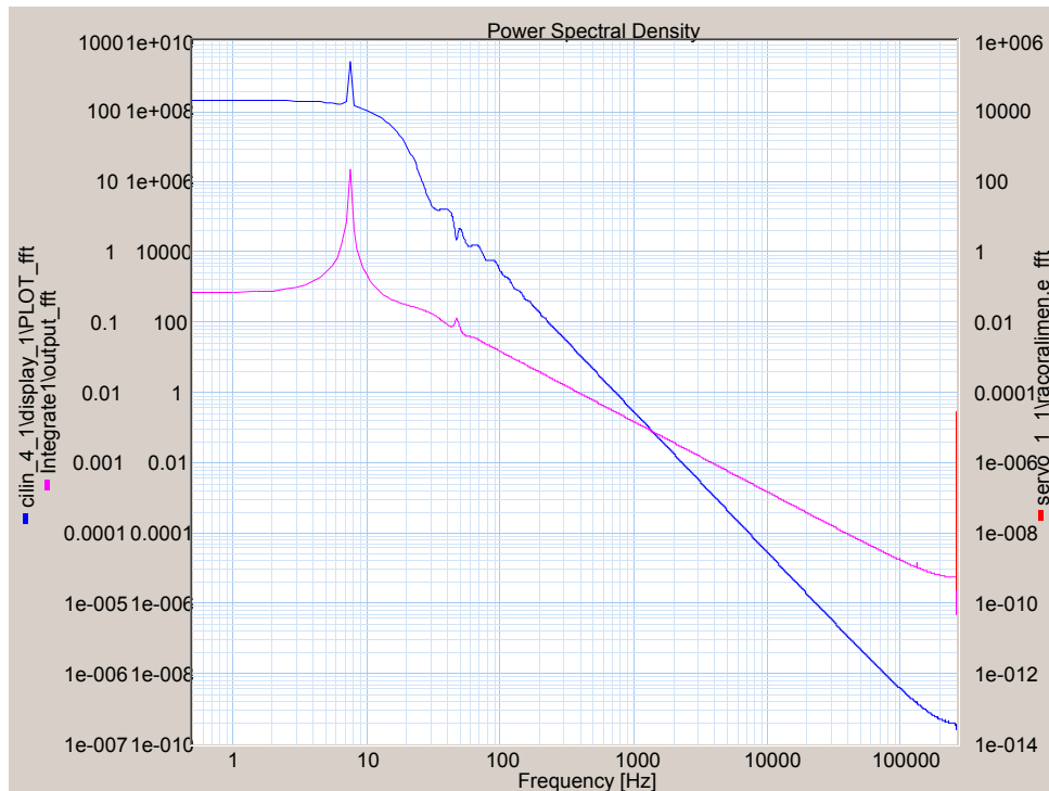
Gráfica 4.25 Respuesta frecuencial con una presión de 4.22 M Pa
