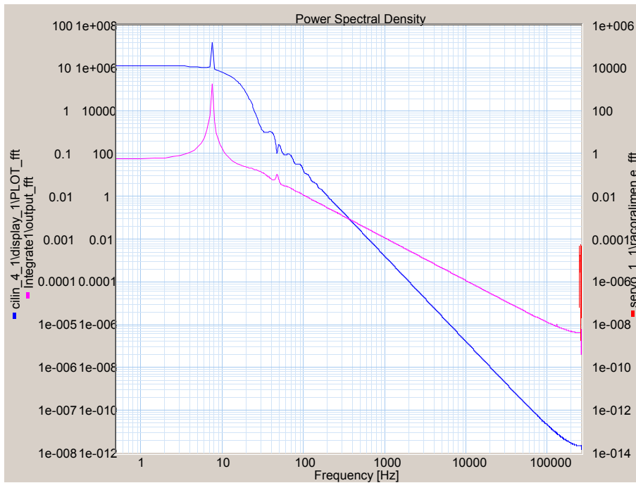
Gráfica 4.38 Respuesta frecuencial con sevoválvula de caudal nominal \frac{1}{2} Azul posición cilindra ( \frac{W}{\bar{W}} / f ) ( 10^{-8} \div 10^2 \text{ cm}^2/\text{Hz} ) Magenta posición extremo viga ( \frac{W}{\bar{W}} / f ) ( 10^{-12} \div 10^{18} \text{ cm}^2/\text{Hz} )
