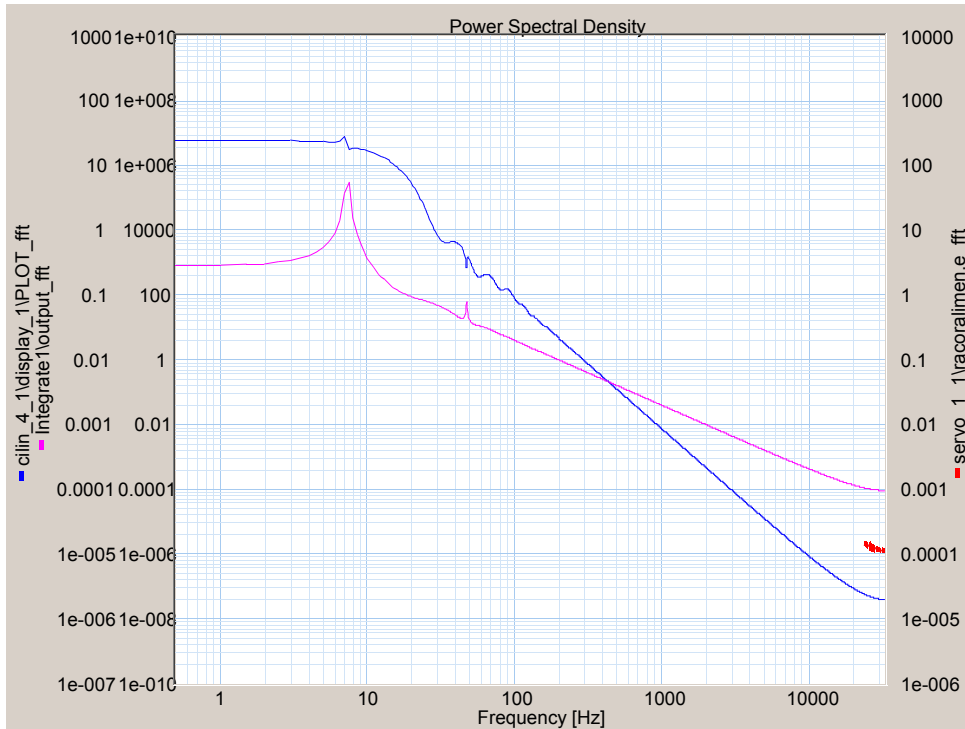
Gráfica 4.9 Respuesta frecuencial con una viga de Aluminio.
