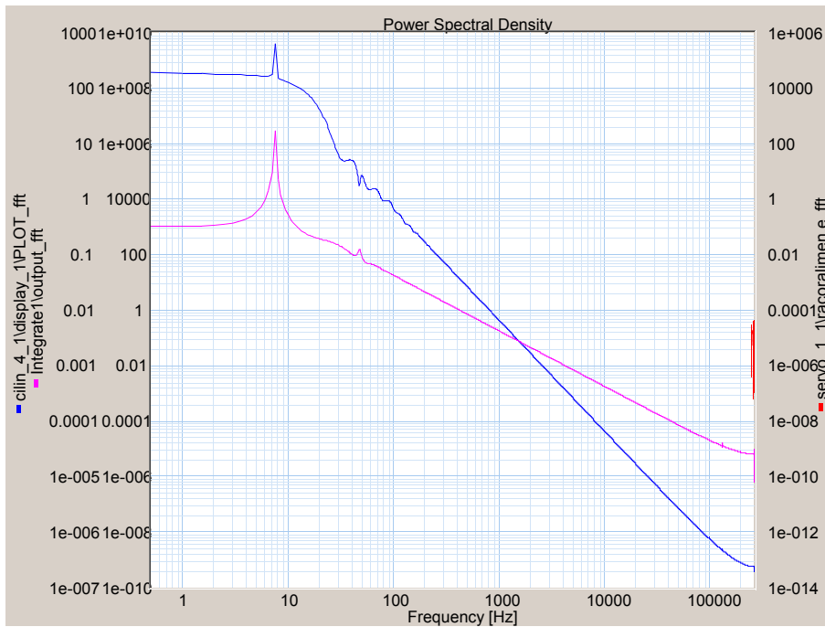
Gráfica 4.72 Respuesta frecuencial con R_{fugas}=1 Azul posición cilindro ( W \overline{W} / f ) (10^{-7} \div 10^3 \text{ cm}^2) Magenta posición extremo viga ( W \overline{W} / f ) (10^{-10} \div 10^{10} \text{ cm}^2)
