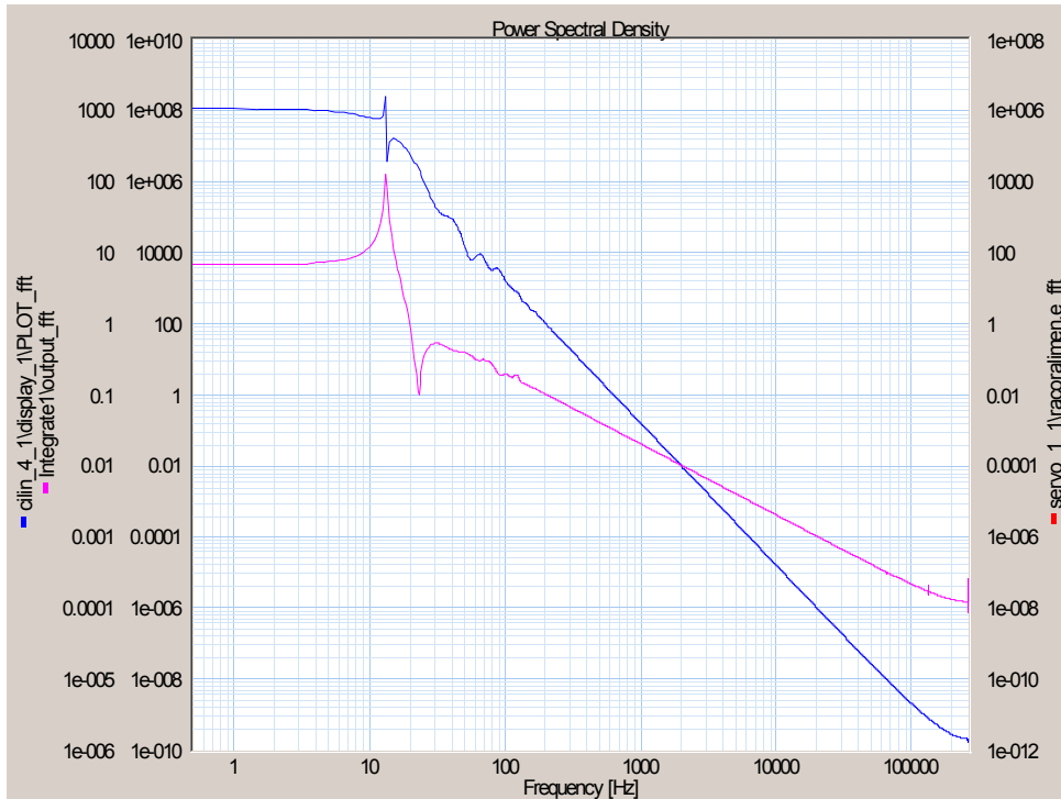
Gráfica 4.15 Respuesta frecuencial con actuador a L/2
