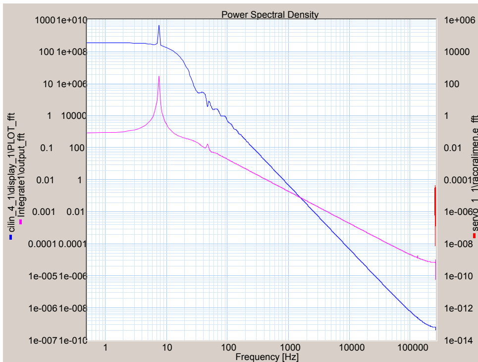
Gráfica 4.40 Respuesta frecuencial con servoválvula de caudal nominal de referencia Azul posición cilindro ( W \bar{W} / f ) (10^{-7} \div 10^3 \text{ cm}^2/\text{Hz}) Magenta posición extremo viga ( W \bar{W} / f ) (10^{-10} \div 10^{10} \text{ cm}^2/\text{Hz})
