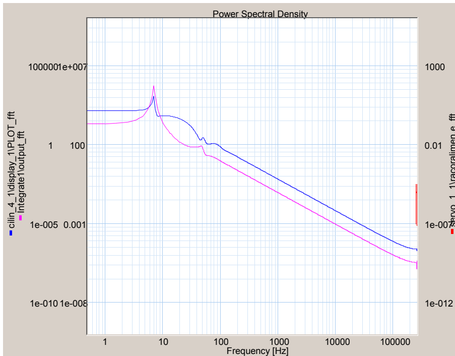
Gráfica 4.52 Respuesta frecuencial con pistón 1/2 servo doble caudal Azul posición cilindro ( \frac{W}{\bar{W}} / f ) (10^{-10} \div 10^5 \text{ cm}^2/\text{Hz}) Magenta posición extremo viga ( \frac{W}{\bar{W}} / f ) (10^{-8} \div 10^7 \text{ cm}^2/\text{Hz})
