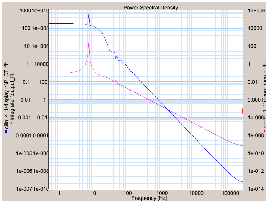
Gráfica 4.68 Respuesta frecuencial con R_{fugas}=10
