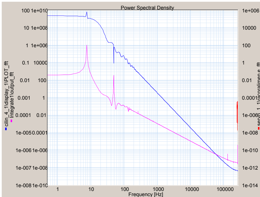
Gráfica 4.32 Respuesta frecuencial con doble área pistón
