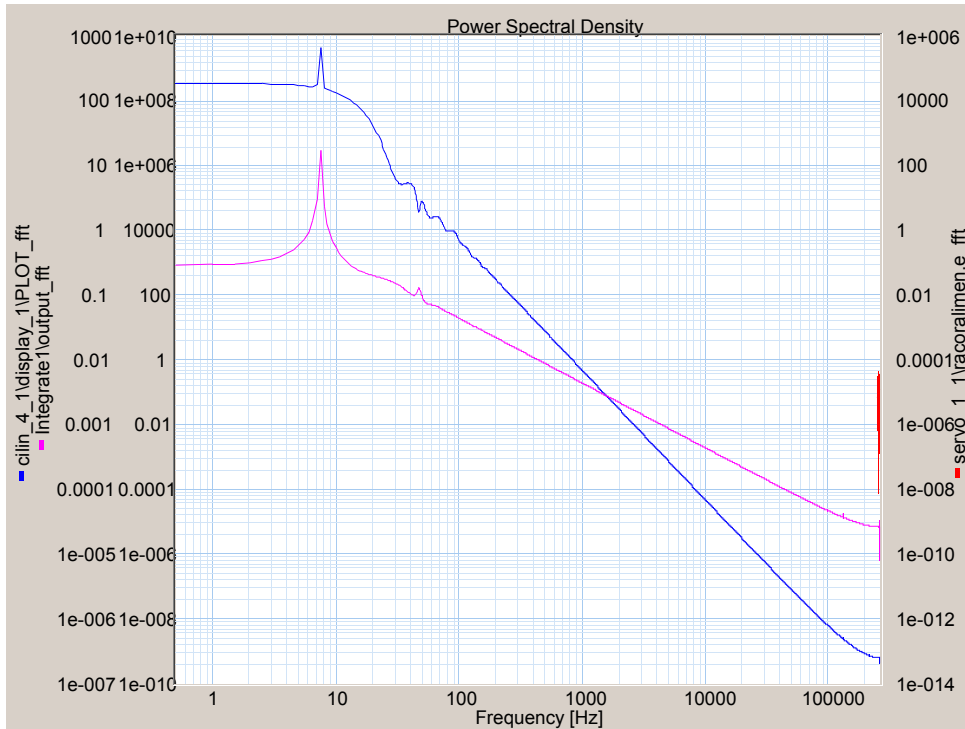
Gráfica 4.13 Respuesta frecuencial con actuador a L/4.
