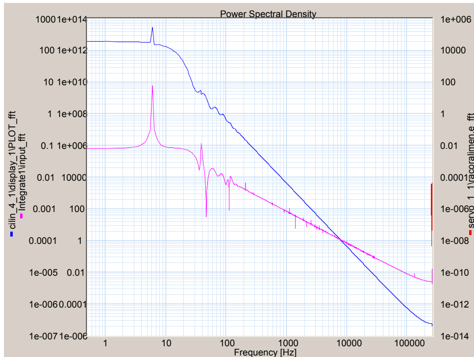
Gráfica 4.5 Respuesta frecuencial en velocidad con una viga de 4mm.
