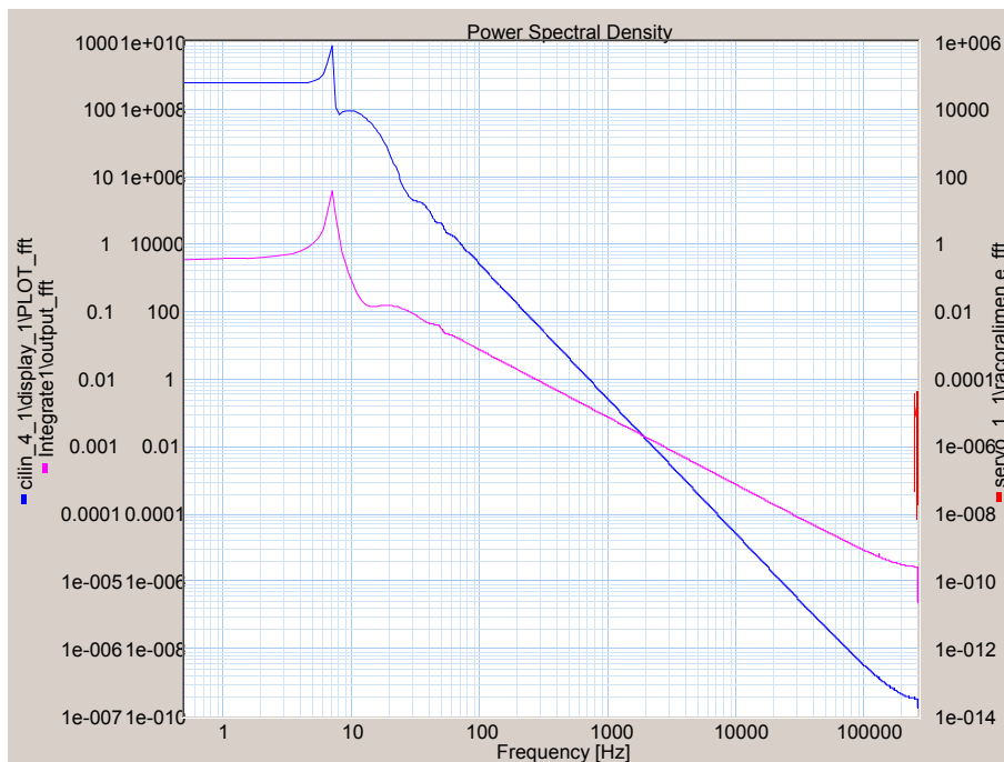
Gráfica 4.46 Respuesta frecuencial con conjunto servoactuador \frac{1}{2}
