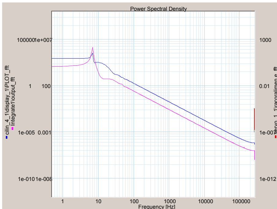
Gráfica 4.28 Respuesta frecuencial con \frac{1}{2} área pistón
