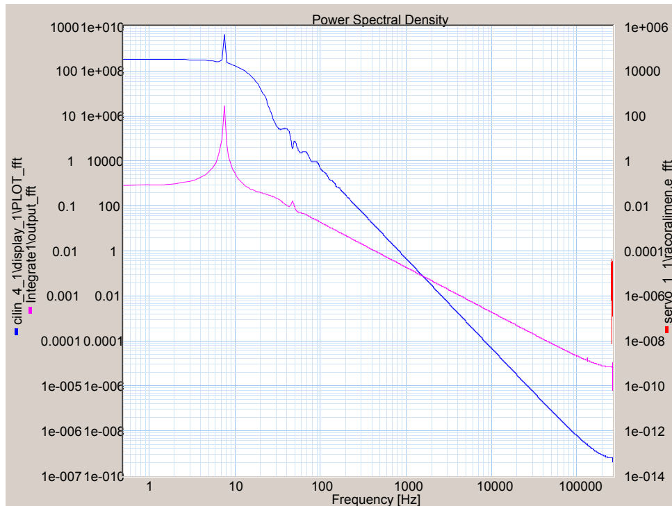
Gráfica 4.2 Respuesta frecuencial del sistema experimental en lazo abierto.
