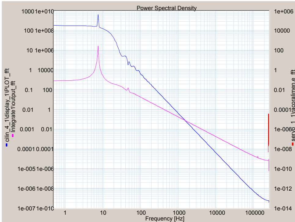
Gráfica 4.23 Respuesta frecuencial con una presión de 5.22 M Pa
