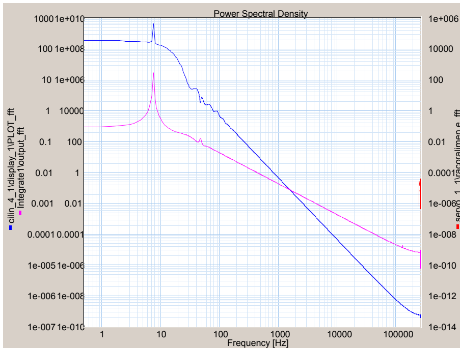
Gráfica 4.70 Respuesta frecuencial con R_{fugas}=3
