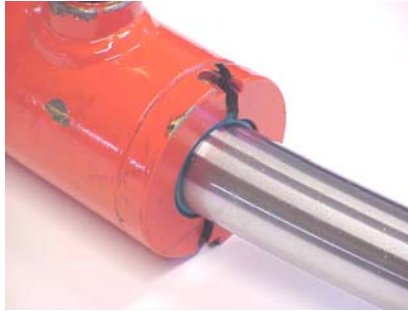
Fig. 5.5 Rotura de tapón en una prueba convencional.
