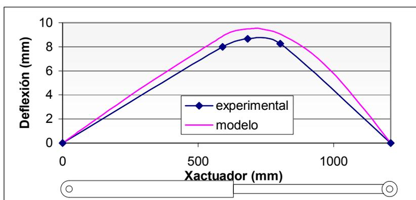
Estas curvas corresponden a la deflexión obtenida del cilindro 'prueba' bi-apoyado, con aplicación de la carga límite admisible (80,6 kN). La diferencia entre teoría y pruebas se justifica en el hecho que, aun reduciendo considerablemente los efectos de fricción en los puntos de apoyo al instalar pasadores de 22mm sobre agujeros de 25,6mm de diámetro, quedan efectos de fricción inevitables, que limitarán la deflexión del actuador.
