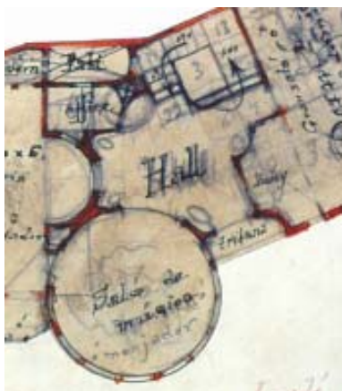
DG-278. Planta del primer piso del primer proyecto, 1922. El hall como espacio resultante de las células independientes que lo rodean.
