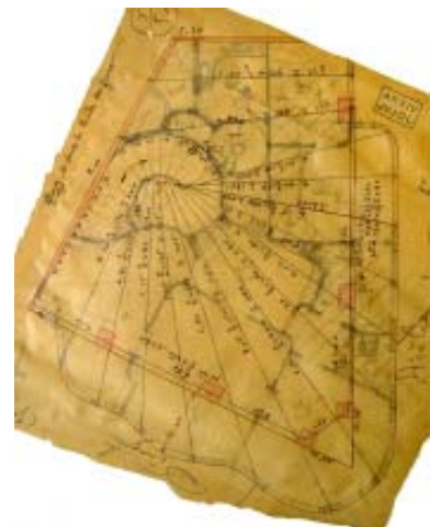
DG-290. Croquis de planta alta, 1923. Dos órdenes: trazo radial y trazo de la distribución.
