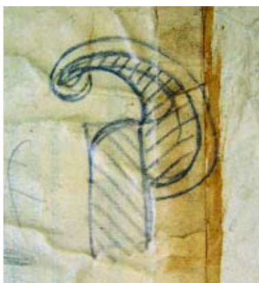
Minúsculo boceto representando una posible sección del pasamanos para la escalera de la Casa Planells. DG-303i.
