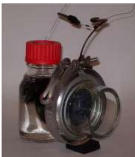
Figura 3.3 Fotografia i esquema d'una MFC tipus càtode a l'aire.
