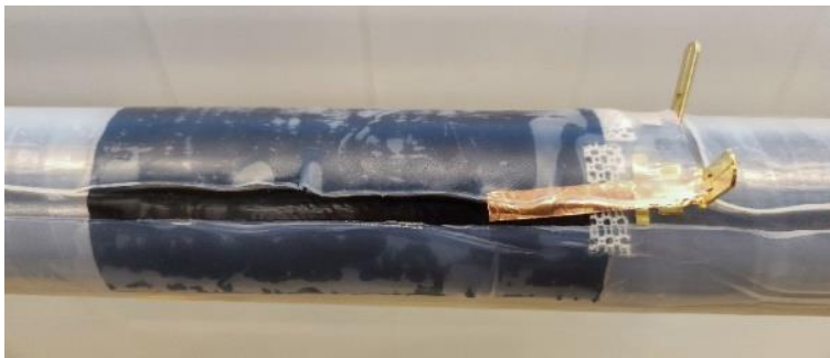
Figura 4.17. Integració del sensor en un tub comercial de silicona.
