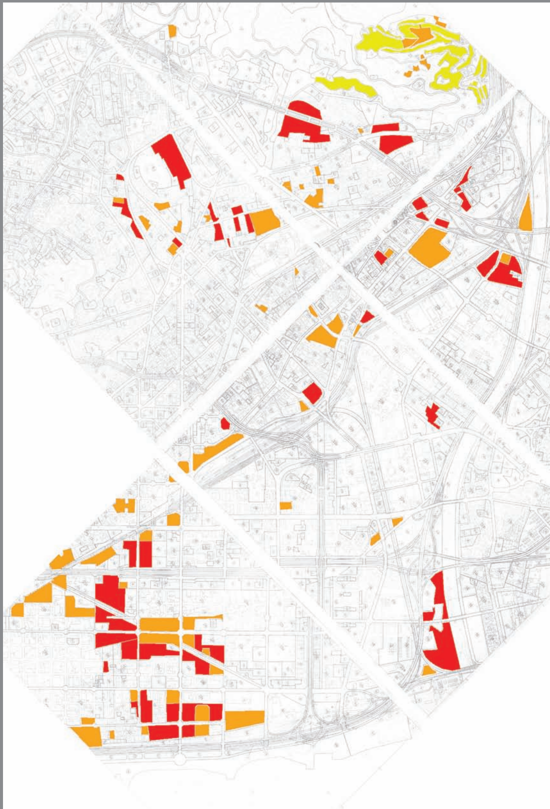
2.3 Plan General Metropolitano 1976. Clasificación del suelo en el sector noreste de Barcelona. Zonas de remodelación física (14, en naranja), renovación urbana por rehabilitación (16, en amarillo) y renovación urbana por transformación de uso existente (17, en rojo).
