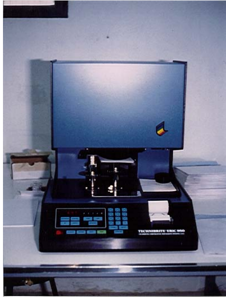
Figura 3.7.- Espectrofotòmetre Technibrite™ Micro TB-1C amb l'opció ERIC 950.
