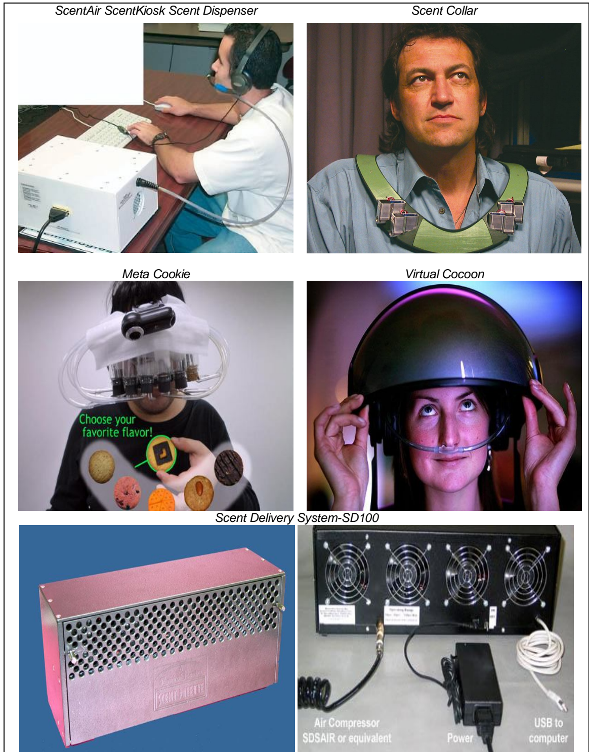
Figura 21. Dispositivos para estimular el olfato en Ambientes Virtuales
