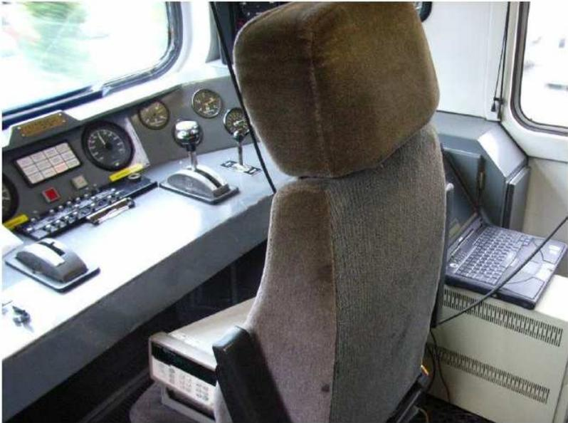
Figura 150. Registrador y UPS embarcados.
