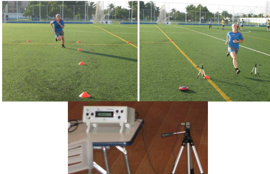
Figura 12. Arriba, Jugadoras del equipo 1 realizando el Test de Illinois con el sistema de fotocélulas. Abajo, sistema de fotocélulas utilizado, con su monitor de tiempos.
