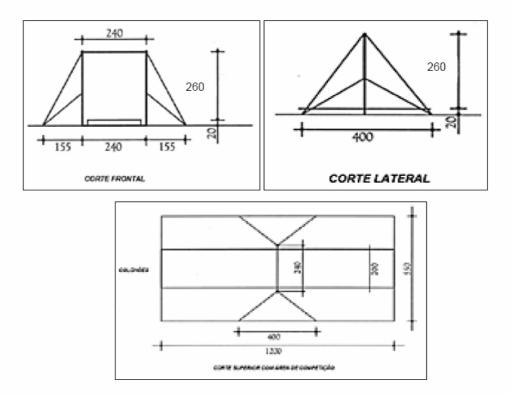
Figura 57, 58 y 59. Barra Fija, medidas oficiales: perspectivas frontal, lateral y superior
