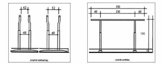
Figuras 50, 51 y 52. Barras Paralelas - Perspectivas superior, frontal y lateral.
