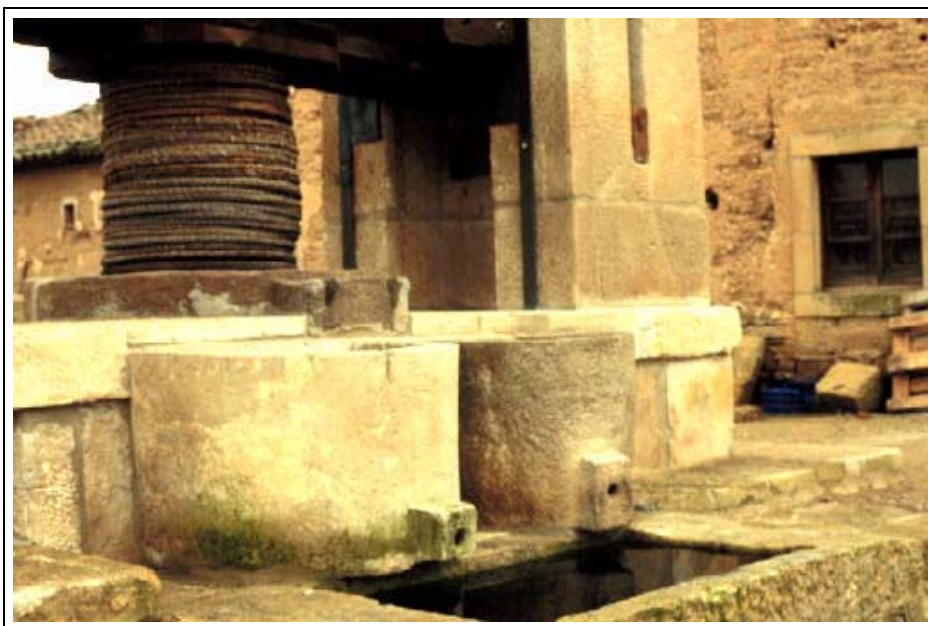
Ilustración 73. Detalle de antigua prensa de Viga en Masia Salat (Borges Blanques) ¿Cuál es el futuro del aceite?
