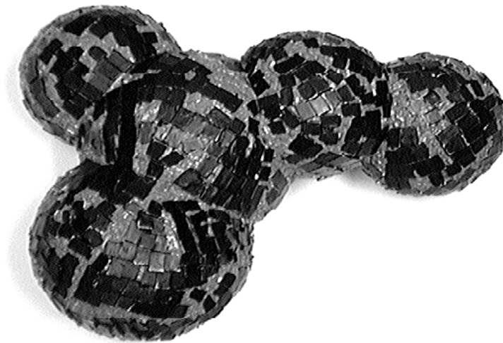
Figura 1.c Model d'agregat de negre de carboni desenvolupat per Sid Richardson Carbon Co.
