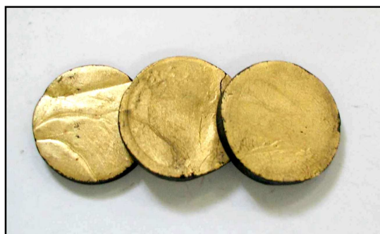
Figura 3.3.1.a Provetes per a la determinació de la dispersió mitjançant mesures elèctriques.
