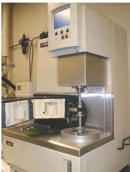
Figura 3.4.3.a Equip ARES per realitzar les mesures viscoelàstiques a baixa freqüència i elongació.
