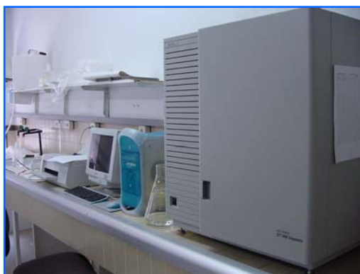
Figura 31.- Secuenciador de DNA para detectar los productos de PCR.
