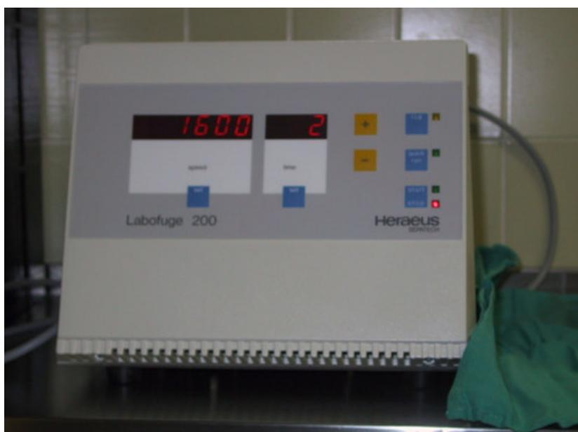
*Figura 12. Centrifugadora Labofuge 200*
