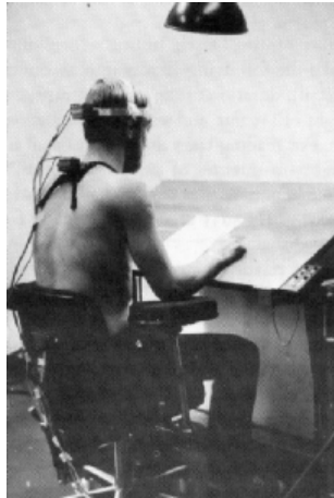
Figura III. 13. Inclinómetro utilizado por Weber et al.
