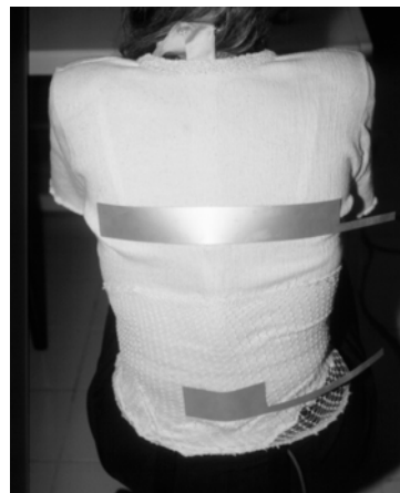
Figura V. 5. Sujeto con el raquímetro bajo la ropa y los electrodos de contacto sobre ella.
