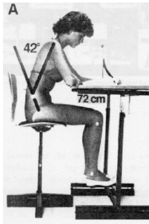
Figura III. 18. Medición de la postura con fotografías.
