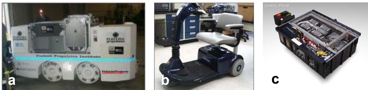
Figura 2-6 .- Movilidad de las sofc. a) Locomotora para minas. b) Silla autónoma para minusválidos. c) Unidad auxiliar de potencia comparada con una batería tradicional de 12 V.
