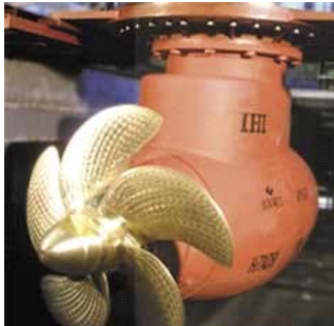
Figura 2-22 .- Motor superconductor de 5000 KV. Sumitomo Electrics (Japón).
