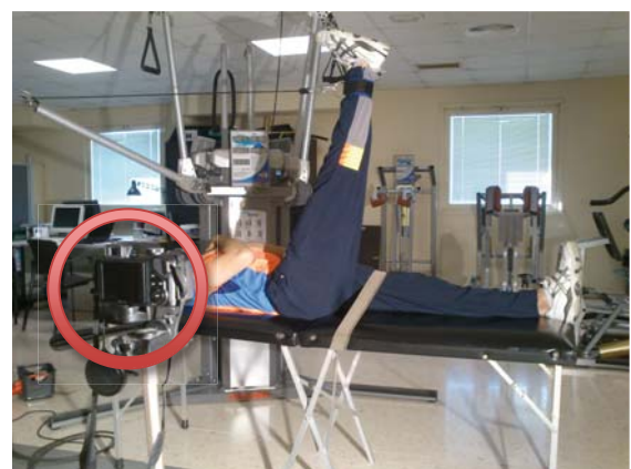
Figura 46: Càmera Canon EOS 400D, extreta de www.canon.es (esquerra), i ubicació de la càmera al trípede perpendicular a la llitera enfocant l'angle del maluc durant les mesures.
