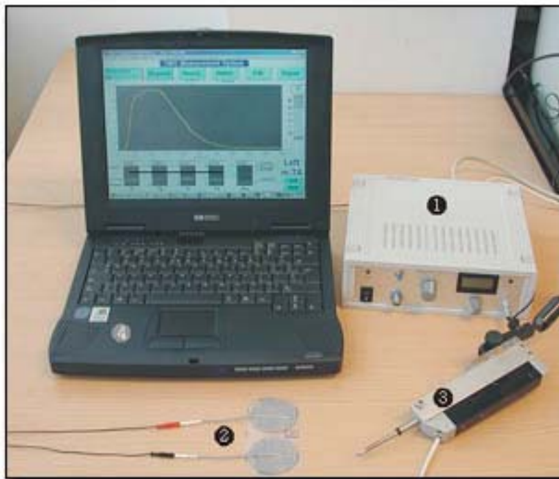
Figura 24: Fotografia de l'aparell extreta de www.tmg-spain.com . Electroestimulador (1), elèctrodes bipolars (2), sensor de desplaçament o tensiomiògraf (3), ordinador amb el software específic (4).
