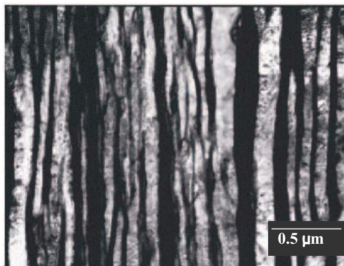
Figura 3. Bainita inferior transformada a 250°C durant 25 dies [8]
