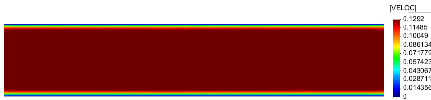
Figura 4.6. Flujo de Poiseuille. Distribución de la velocidad para \Delta P = -250 \text{ Pa/m} .
