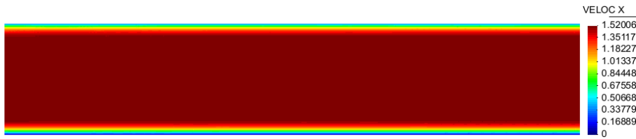
Figura 5.16. Flujo de Couette, n = 0.5 . Distribución de la velocidad para \Delta P = -300 Pa/m.
