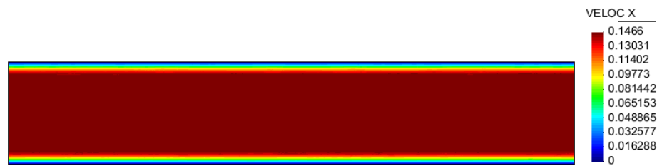
Figura 5.9. Flujo de Poiseuille, n = 2 . Distribución de la velocidad para \Delta P = -266.67 \text{ Pa/m} .
