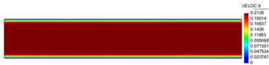
Figura 4.13. Flujo de Couette . Distribución de la velocidad para \Delta P = -266.67 Pa/s.
