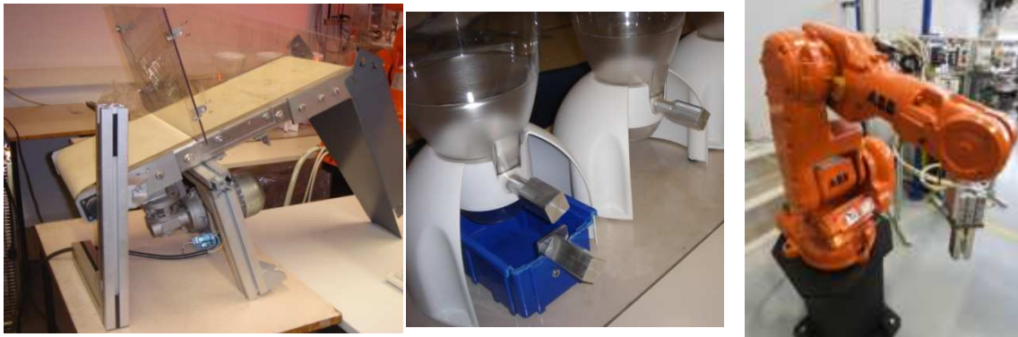
Figura 6.3-4. Esquerra: Cinta transportadora automàtica amb caiguda sobre pla d'identificació. Centre: Dispensadors de peces i Contenidors adaptats per a ser utilitzats per part del Robot antropomòrfic. Dreta: Robot antropomòrfic de 6 eixos.
