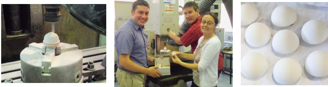
Figura A4.3-4. Fabricació per mecanització de la geometria exterior de les Copes Bases Ceràmiques objecte del projecte. Esquerra: Fresatge exterior de la Copa. Central, J. Minguella, R. Uceda i R.M a Rodríguez preparant mostres de copes a la Fundació CIM el 7 de Juliol de 2012. Dreta: Geometria de la Copa Base Mecanitzada amb èxit,
