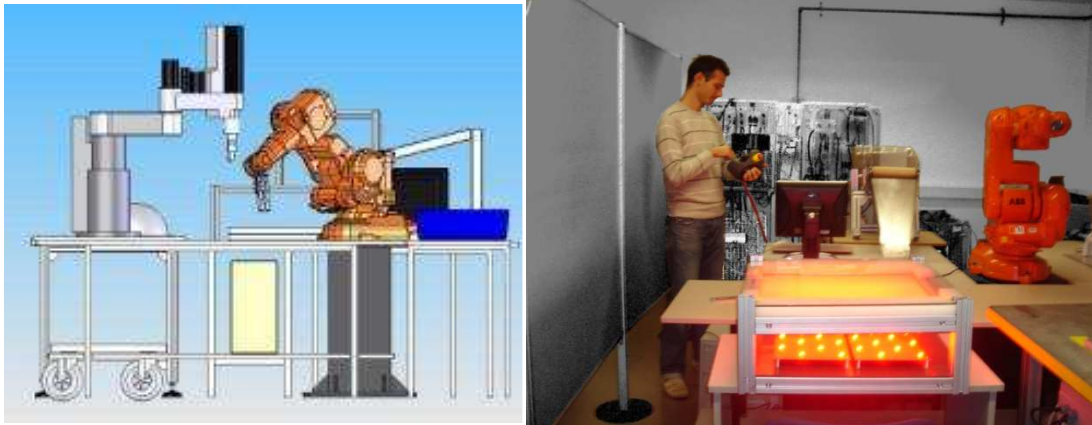
Figura 6.3-8. Esquerra: Disseny 3D dels elements de la Cèl·lula de Fabricació del Projecte "Estació de Muntatge Universal". Dreta: Fotografia de part dels elements (rampa, il·luminació per contrast, robot antropomòrfic) en les etapes d'assaig i test.
