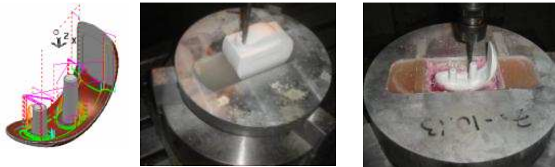
Figura A4.3-1. Simulació CAM i etapes de fabricació per a la mecanització de l'exterior i l'interior d'una pròtesis de genoll.
