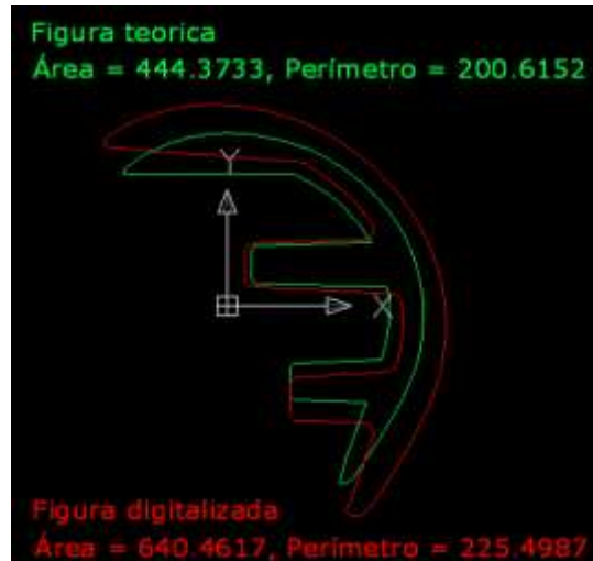
Figura A4.3-2. Mesura del contorn d'una pròtesi de genoll: Geometria teòrica (contorn verd) i Geometria deformada obtinguda després d'un procés de sinterització (contorn vermell).
