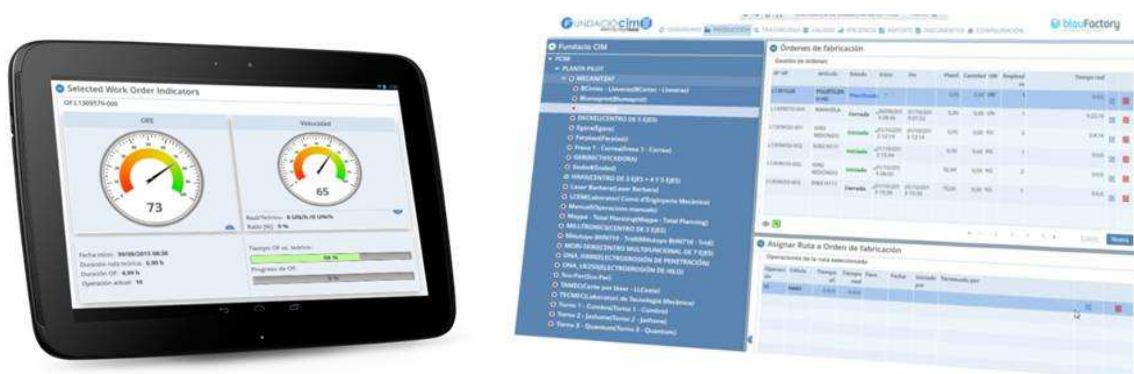
Figura A3.1-1. Esquerra: Captura de pantalla de l'aplicació OpenMES de ENCO (BlauFactory) amb indicadors d'eficiència per a tablettes. Dreta: Captura de pantalla del gestor d'Ordres de Fabricació de la mateixa aplicació, que s'utilitza a la Fundació CIM per al control de la producció en temps real. Font: Fundació CIM.
