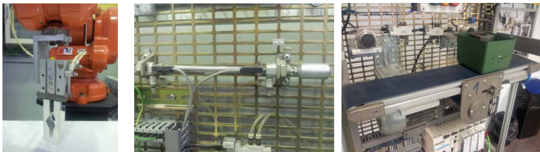
Figura 3.2-7. D'esquerra a dreta, imatges de diferents tipus d'accionaments Agafador (pinces), Posicionador (pistó) i Transportador (cinta de banda). Font: Fundació CIM
