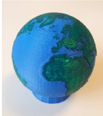
Figura A4.3-7. Esquerra: Màquina d'impressió 3D per FDM amb capçal multimaterial. Dreta: Figura impresa en FDM multimaterial.
