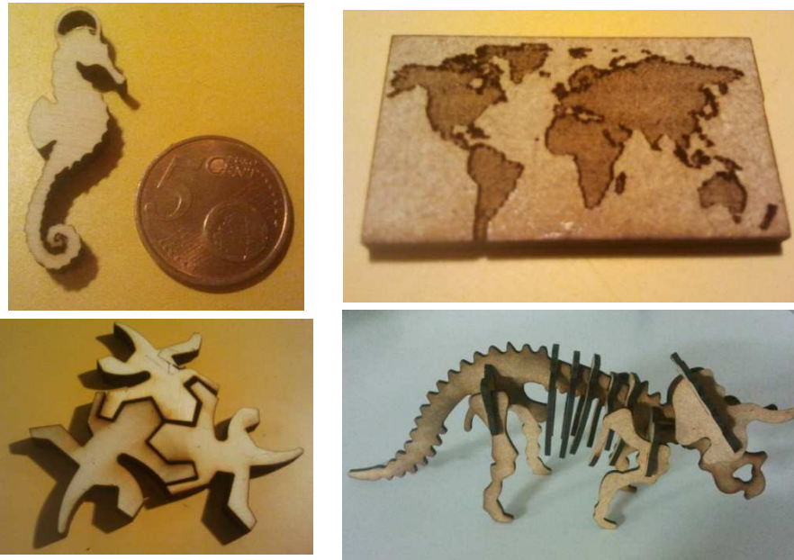
Figura 7.3-3. Peces de fusta tallades i gravades amb làser domèsticament per personal de la Fundació CIM. Font: Cortesia de Gerard Mosquera.
