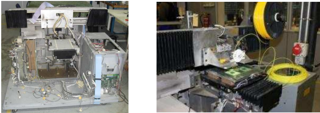
Figura 6.2-2. Esquerra: Bancada d'impresora 3D de cera durant el procés de desmuntatge de components. Dreta: Màquina de Fabricació Additiva per deposició de fil de plàstic desenvolupada ja integrada sobre l'arquitectura de 3 eixos cartesianes.
