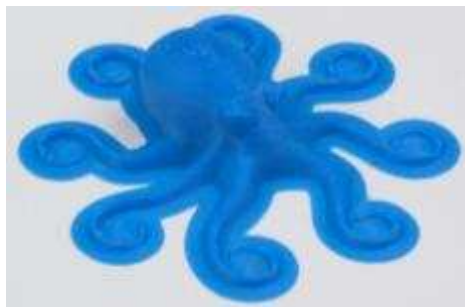
Figura A5.3-2. Peça impresa amb tecnologia FDM incorporant un suport de tipus “brim” a tota la superfície en contacte amb la plataforma de construcció gràcies al programa Slic3r. Font: [13]
