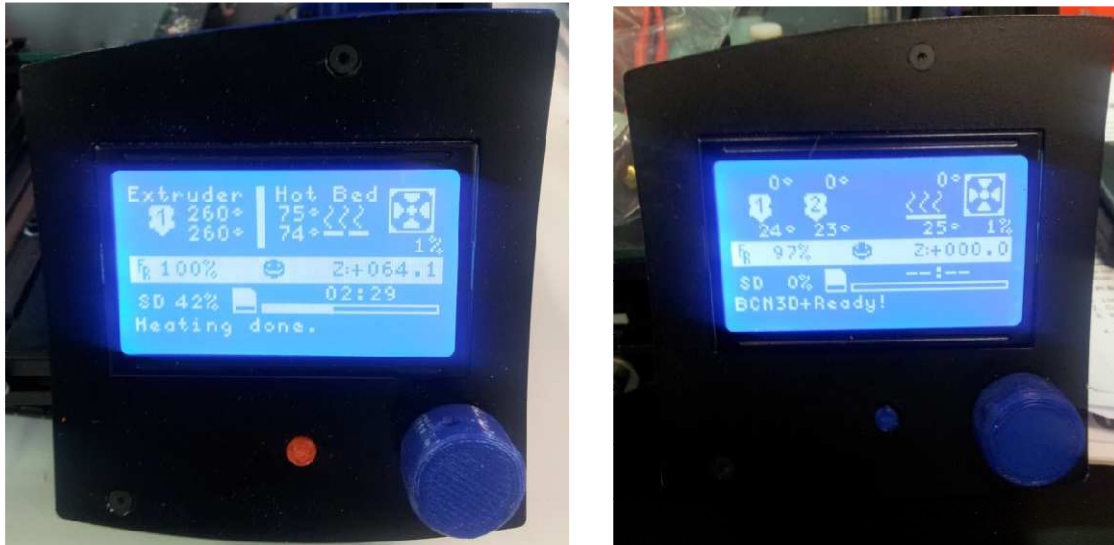
Figura A2.3-5. Detall de dues pantalles del firmware de la impressora BCN3D+ personalitzat per a una configuració d'un sol capçal (Esquerra) o per a dos capçals independents (Dreta).
