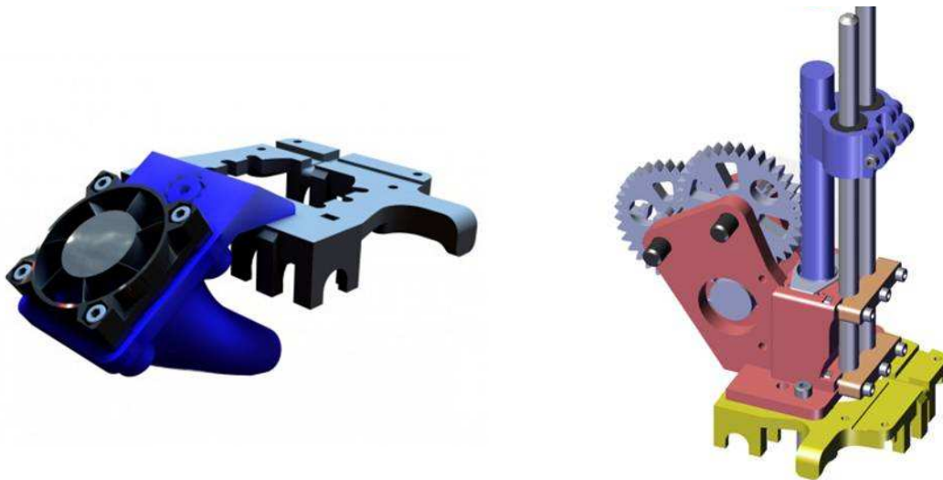
Figura 6.2-4. Esquerra: Ventilador de capa per a la consolidació de les capes de fil en el moment de la impressió. Dreta: Capçal específic per a la deposició de material en forma de pasta en lloc de bobines de fil.
