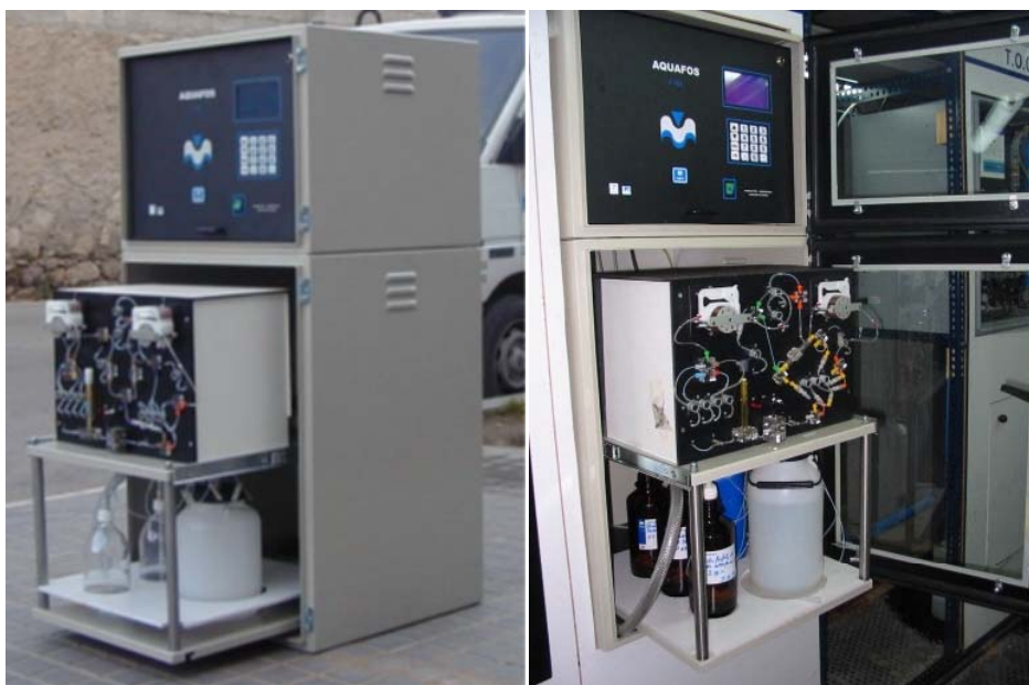
Figura 8.9: Fotografia del prototipus de l'analitzador d'ió fosfat AQUAFOS. Perspectiva on es pot apreciar la safata corredera per a les operacions de manteniment. La imatge de la dreta mostra l'analitzador ja instal·lat en la E.A.A.
