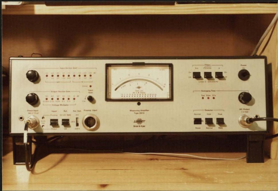
Fig. 33-. Amplificador de medida B & K
