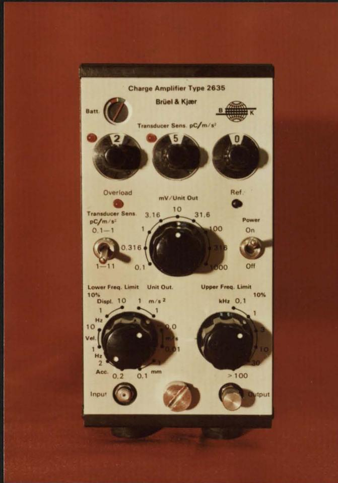
Fig. 30-. Amplificador de carga
