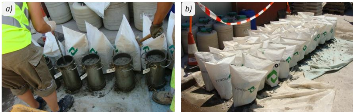
Figura 4.3: a) Llenado de moldes (método picado) y b) total probetas 1ª campaña
