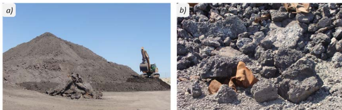
Figura 3.2: a) Primera separación con maquinaria y b) Trozos de dimensiones mayores que 500 mm
