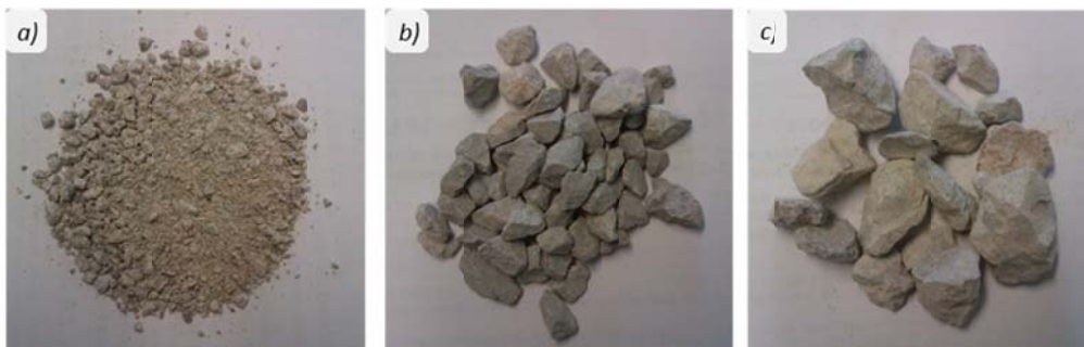
Figura 3.6: Aspecto del árido calizo: a) arena (0/4); b) gravilla (4/10) y c) grava (10/20)
