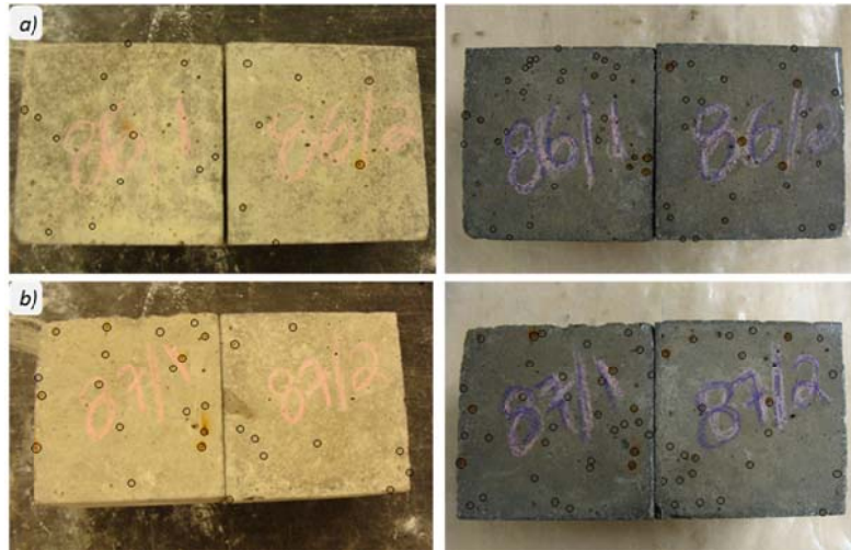
Figura 5.8: Puntos de óxido probetas cúbicas: a) HSS2b y b) HSC1b
