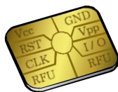
Figura 3.2: Estructura dels punts de contacte de la targeta intel·ligent
