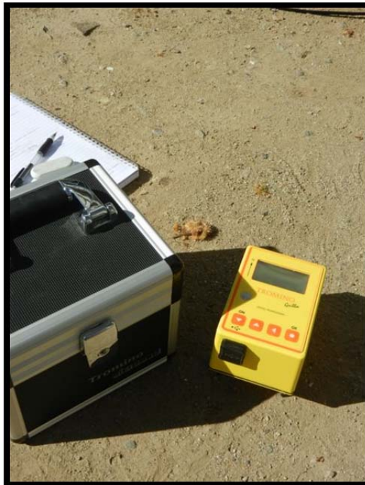
Figura 3.1 Equipo de Adquisición. Sismógrafo portátil Tromino.
