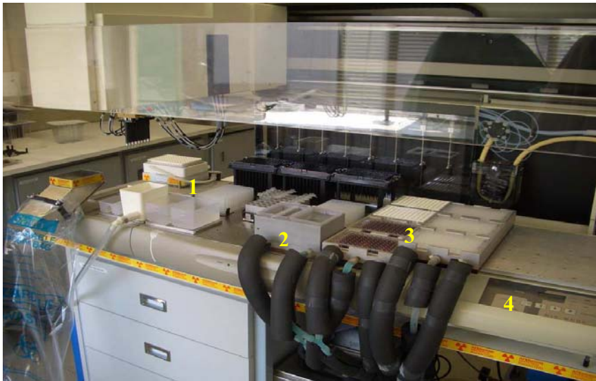
Figura 22. Estació robotitzada Multiprobe II HT Ex (Perkin Elmer). 1. Sistema Multiscreen 2. Reservoiris per reactius termostatitzat 3. Incubadors per a plaques termostatitzats 4. Agitador orbital
