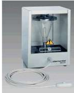
Figura 5.1. Equipo para la combustión en frasco de oxígeno Mikro-k de Elementar inc 31 .
