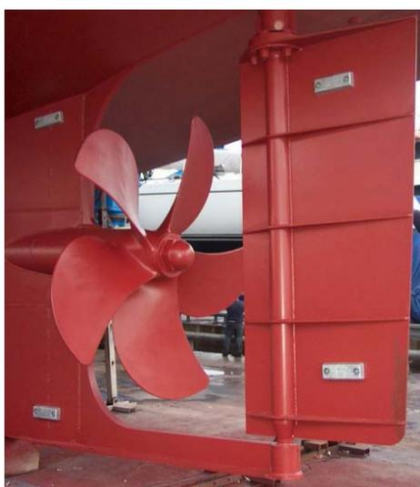
Figura 4.44: Hélice acoplada a eje de cola. Fuente. Propia
