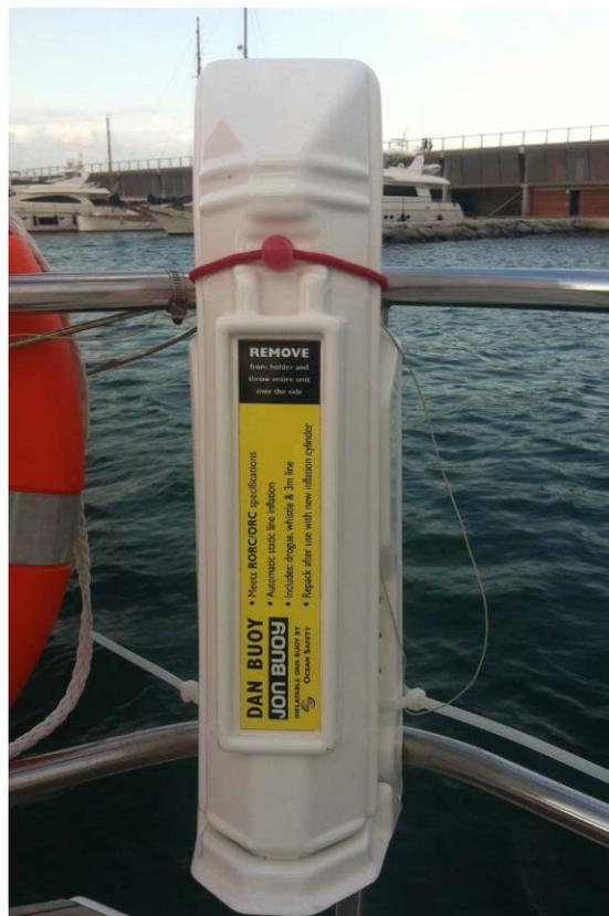
*Figura 6.7: Dispositivo de Dan Buoy. Fuente: Propia*
