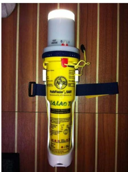
Figura 4.92: Respondedor de radar de 9 GHz. Fuente: Propia
