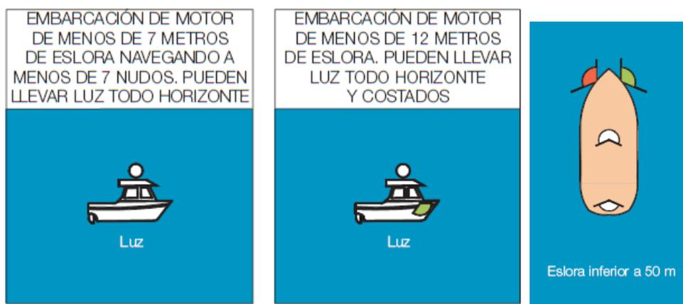
Figura 4.71: Resumen COLREG para embarcaciones a motor. Fuente: Propia
