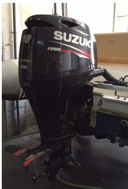
Figura 4.41: Motor fuera borda fijado en el espejo de popa de una embarcación semirrígida. Fuente. Propia
