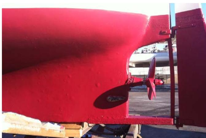
Figura 4.28: Casco embarcación de materiales compuestos con signos de ósmosis. Fuente: Propia
