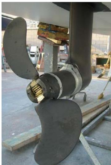
Figura 4.25: Ánodo de zinc en sistema sail drive embarcación de vela. Fuente: Propia
