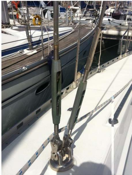
Figura 4.51: Tensores o terminales. Fuente: Propia
