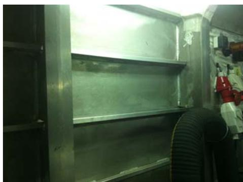
Figura 4.27: Casco metálico de aluminio. Fuente: Propia
