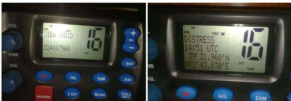
Figura 4.59: VHF fijo con DSC - MMSI y coordenadas del GPS respectivamente. Fuente: Propia
