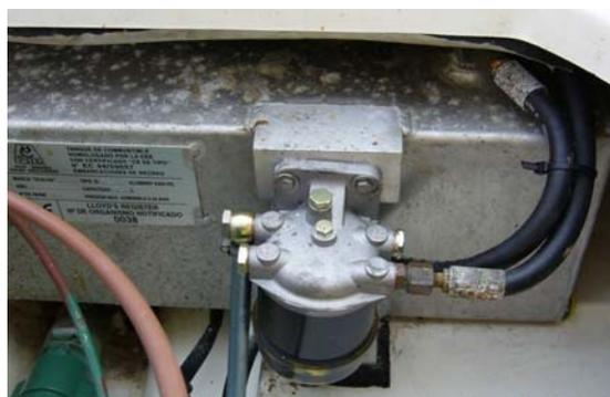
Figura 4.31: Tanque de combustible de aluminio. Fuente: Propia
