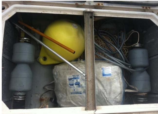
*Figura 6.4: Ejemplo de balsa mal estibada. Fuente: Propia*
