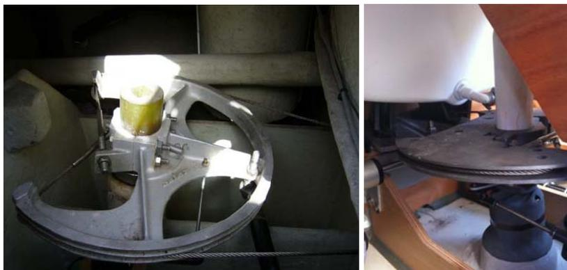
Figura 4.23: Sistema mecánico de sujeción a la mecha y guardines. Fuente: Propia
