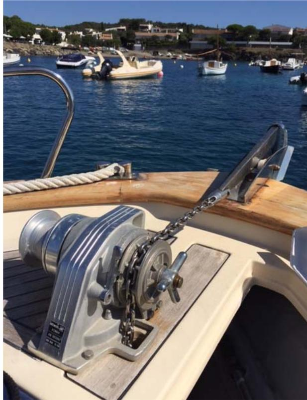
Figura 4.62: Fondeo eléctrico con ancla de arado. Fuente: Propia
