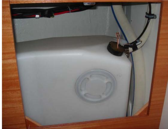
Figura 4.63: Depósito de retención de vertidos. Fuente: Propia
