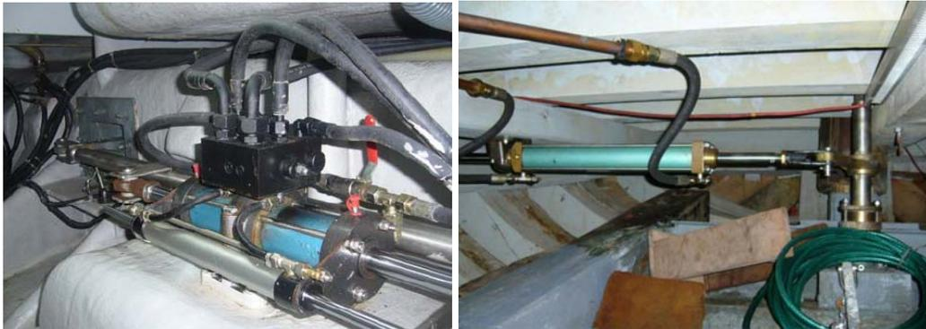
Figura 4.24: Sistema de transmisión hidráulico (servomotor) en embarcaciones de recreo. Fuente: Propia
