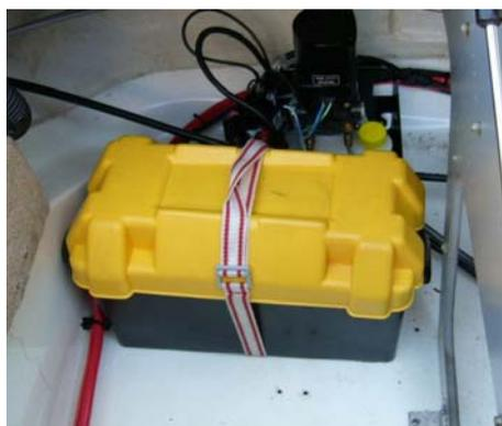
Figura 4.54: Caja estanca de batería con sistema de sujeción. Fuente: Propia
