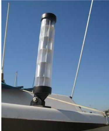
Figura 4.79: Reflector de radar
