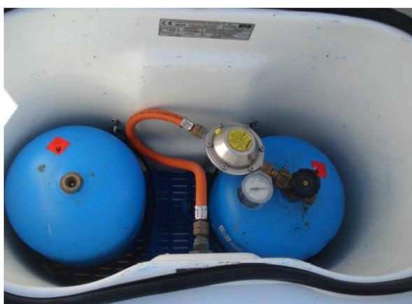
Figura 4.22: Bombona de gas y tubo flexible ubicada en la bañera de una embarcación. Fuente: Propia
