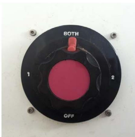
Figura 4.55: Desconectador de baterías. Fuente: Propia
