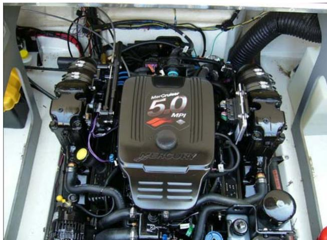
Figura 4.45: Vista general motor dentro fuera borda de gasolina. Fuente: Propia
