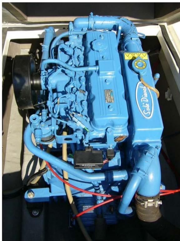
Figura 4.46: Vista general motor intraborda diesel. Fuente: Propia
