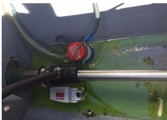
Figura 4.42: Línea de eje interior casco. Fuente: Propia
