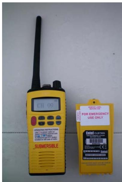
Figura 4.93: Equipo radiotelefónico bidireccional portátil de VHF (SMSSM). Fuente: Propia
