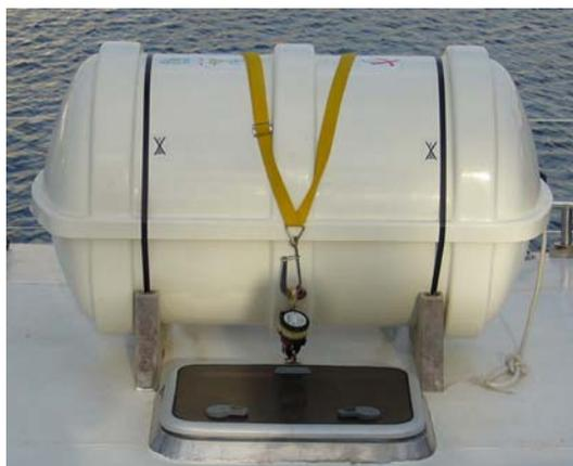
Figura 4.67: Balsa salvavidas con dispositivo de zafa hidrostática. Fuente: Propia
