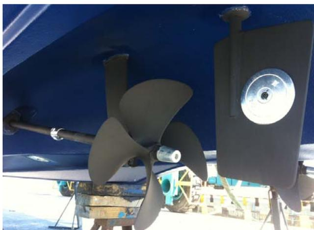
Figura 4.26: Ánodo de zinc en eje de cola, hélice y pala del timón. Fuente: Propia
