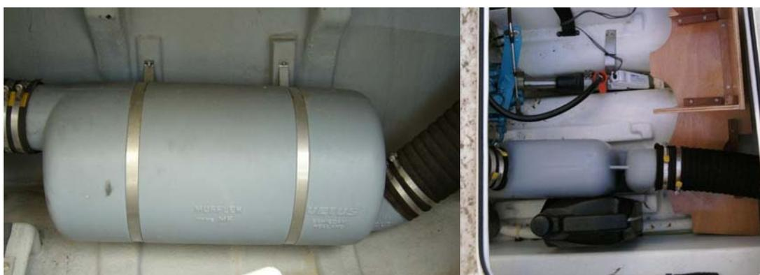
Figura 4.36: Colector/silenciador del sistema de escape de una embarcación de recreo. Fuente: Propia
