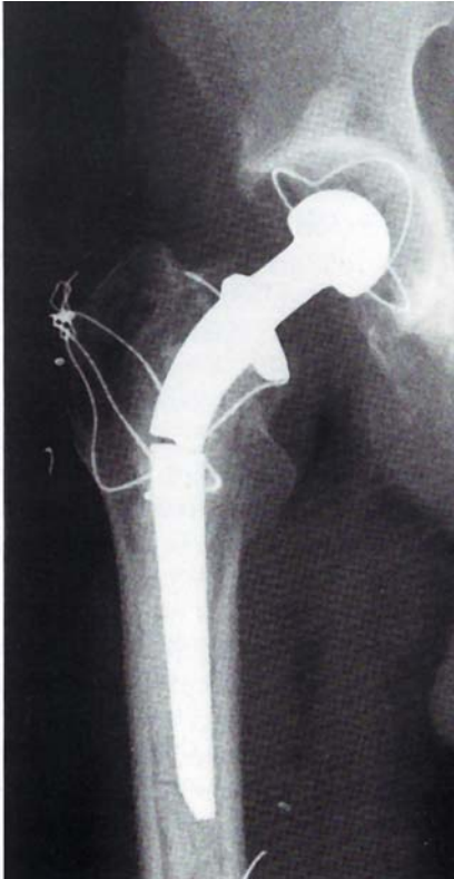
Figura 1.6.5 Ruptura de la tija femoral (Kozinn et al , 1989)
