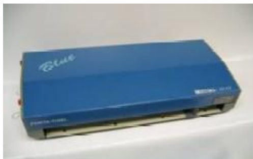
Figura 9. Impresora porta-thiel, para imprimir en braille desde el ordenador. Fuente: Banco imágenes de ONCE
