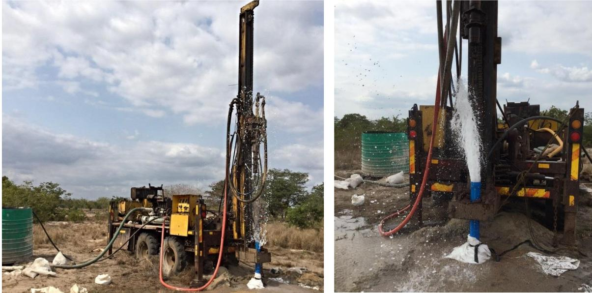
Figura 6. Ejemplos del proceso de perforación de un pozo de agua en las comunidades
