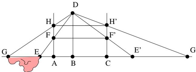
Figura 2.2: Al suprimir la condición de igualdad de distancia entre las estacas, los triángulos  $\triangle DGE$  y  $\triangle DE'G'$  no son congruentes
