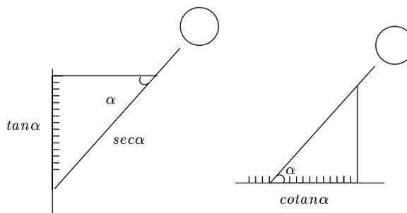
Figura 4.3: Relojes de Sol. Para cada ángulo, la *tangente* era calculada como la longitud de la sombra. El mismo reloj colocado perpendicularmente sobre el suelo proporcionaba las razones inversas.
