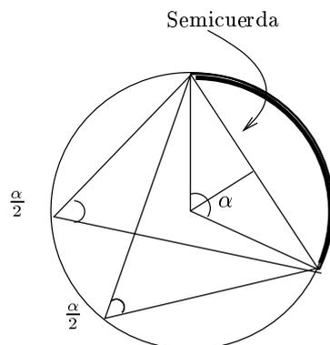
Figura 4.2: Una propiedad geométrica nos asegura que, para una misma cuerda, el ángulo medido sobre el centro de la circunferencia es exactamente el doble que el ángulo medido sobre el borde de la circunferencia.
