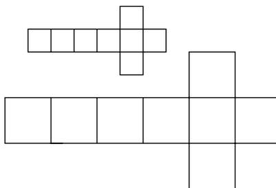
Figura 7.2: Un aumento de longitud en la arista del cubo produce un aumento cúbico en el volumen.
