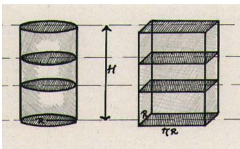
Figura 6.1: Las secciones del cilindro y el prisma tienen igual área.
