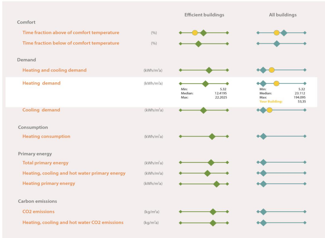
Figura 52. SEIS: Benchmarking de eficiencia energética. Comparación del rendimiento del edificio con el rendimiento de todos los edificios registrados en el sistema en base a diversos indicadores (confort, demanda, consumo, emisiones de CO 2 , etc.). Fuente: http://www.seis-system.org/ . © ARC Ingeniería y Arquitectura La Salle.
