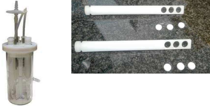
Figura 17. Se muestra el reactor con los brazos, las entradas y la salida (izquierda) y los brazos con los tres cupones cada uno (derecha).
