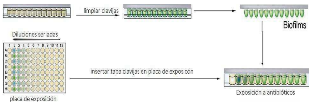
Figura 10. Exposición de los biofilms a diferentes concentraciones de antibiótico. Tras la incubación de los biofilms, se hace un lavado y se trasladan a una placa que contiene las diferentes concentraciones de antibiótico. Fuente: ©Innovotech Inc.
