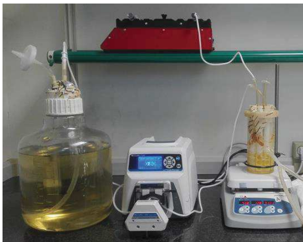
Figura 18. Sistema CDC Biofilm Reactor con todos sus componentes en funcionamiento. Se observa el medio de cultivo que entra por infusión continua en el reactor por la bomba peristáltica, la bomba de dispensación de antibiótico, la placa termostato con agitación y el reactor.
