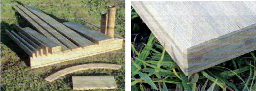
297. I. Paneles de cinco láminas en guadua, 30mm de espesor
