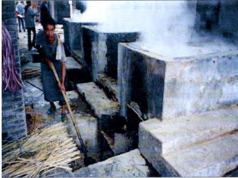
301. *Proceso de blanqueamiento con H<sub>2</sub>O<sub>2</sub> en calderas de cemento*
