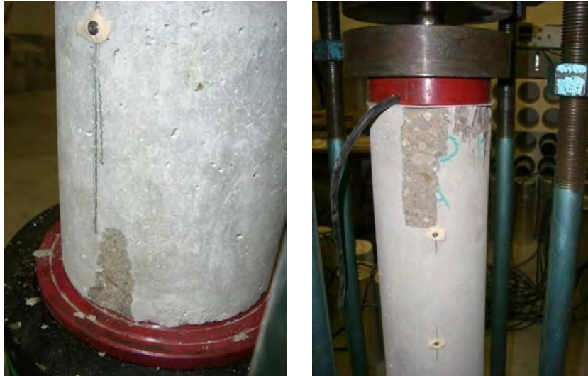
Figura 3.15 – Fisuras en el ensayo de fluencia situadas junto a las rótulas a) Rótula inferior b) Rótula superior.
