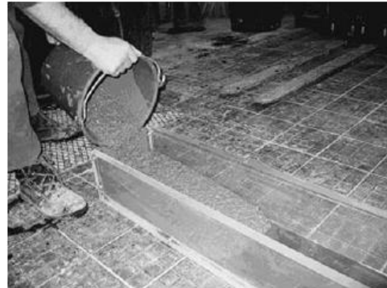
Figura 2.6 – Propuesta para medir el umbral de cizallamiento. (Roussel, 2007)
