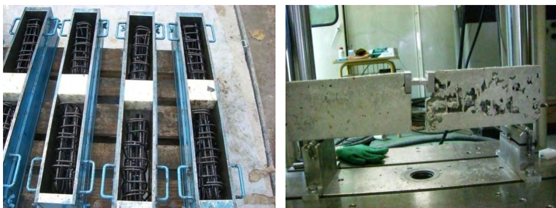
Figura 3.12 – Probetas de adherencia. a) Antes del hormigonado. b) Acabado inadecuado
