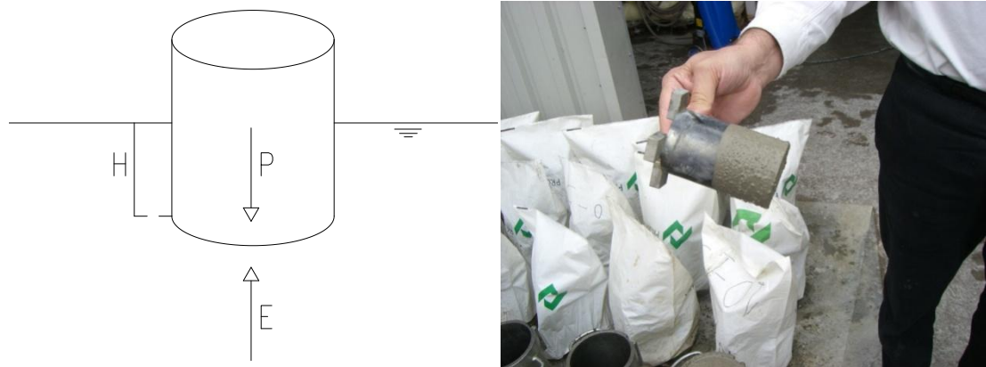
Figura 7.6 – Ensayo de penetración a) Principio de Arquímedes P=E b) Resultado 4ª amasada.
