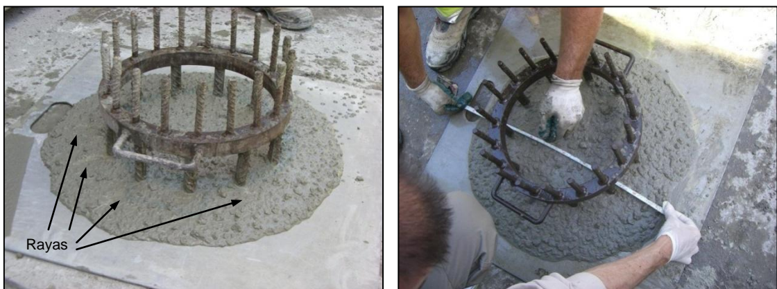
Figura 5.4 – Ensayo de escurrimiento con anillo, en hormigones de 60 MPa: a) C60 y b) D60
