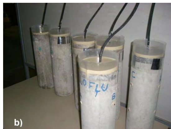
Figura 3.9 – Refrentado mediante resina epoxi
