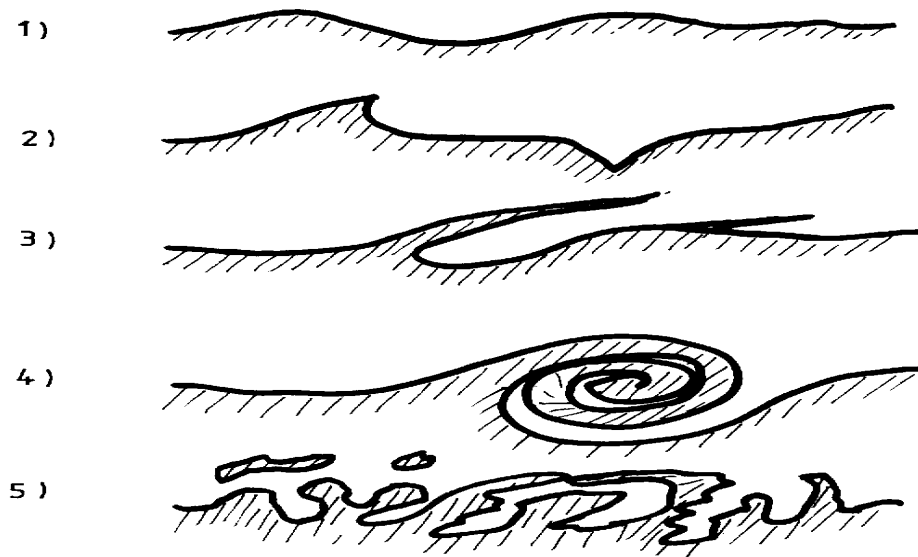
Figura 2.15: Diferentes tipos de inestabilidades identificadas en los experimentos de Redondo (1987). 1) Ondas internas, 2) Ondas de Hölmboe, 3) Filamentos proyectados por ondas solitarias, 4) K-H y 5) Turbulencia.
