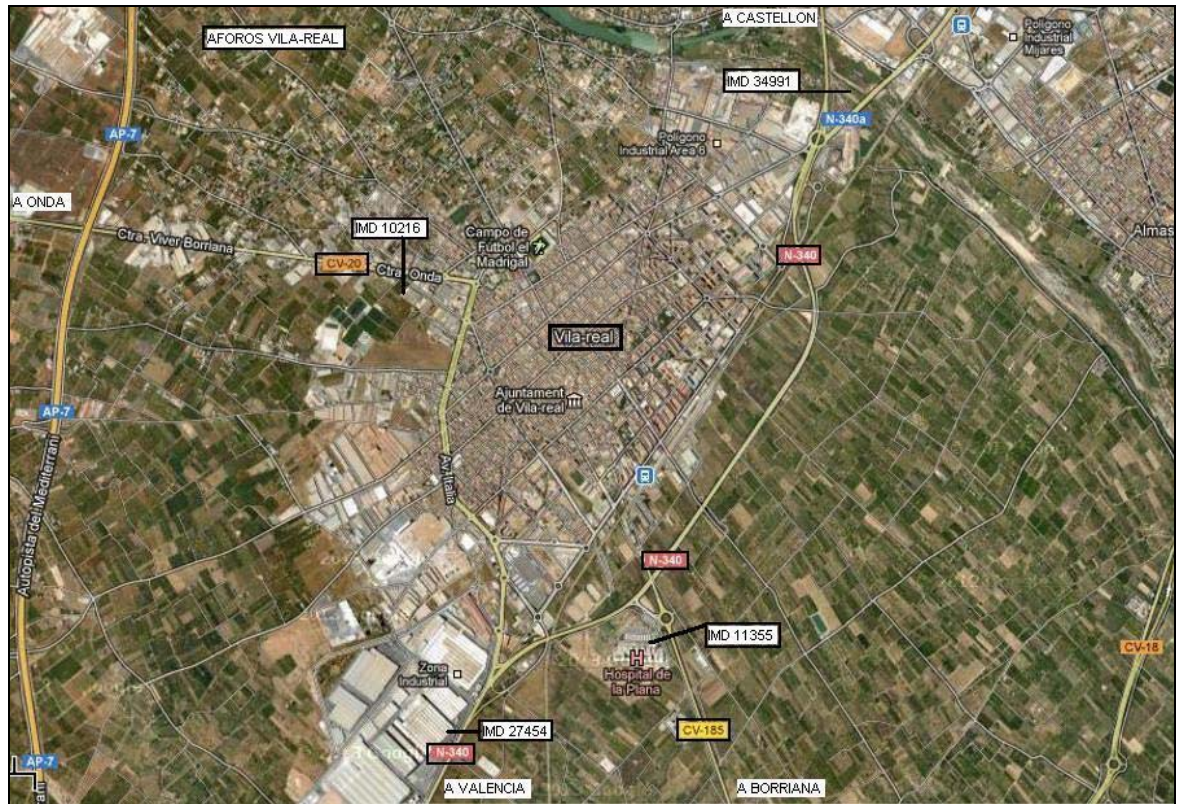
Fig. II. 9.3.1. Mapa de las intensidades medias diarias de las carreteras de acceso a Vila-real
