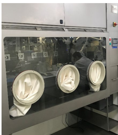
Figura III - 7. Imagen de la cabina de humedad controlada utilizada en el desarrollo de la tesis.
