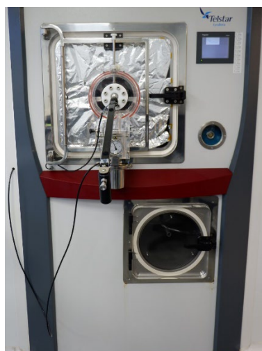
Figura III - 2. Imagen del extractor de muestras acoplado al liofilizador Lyobeta 20, en las instalaciones de los Laboratorios Reig Jofre de Barcelona.
