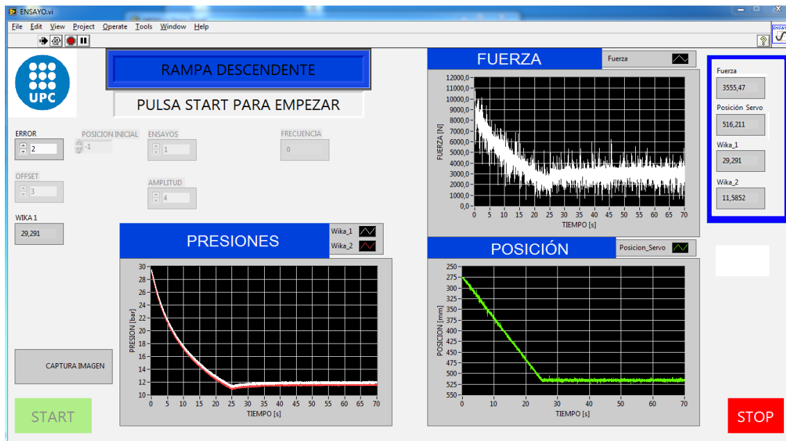
Figura 5.6: Imagen del software (LabVIEW), utilizado para la realización de los ensayos en rampa descendente para una frecuencia de 0.02 Hz, a una velocidad de extensión de 9.6 mm/s y carrera de 240 mm.
