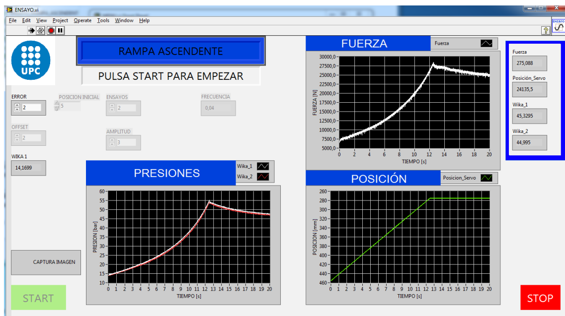
Figura 6.3: Imagen del software (LabVIEW), utilizado para la realización de los ensayos en rampa ascendente para una frecuencia de 0.04 Hz, a una velocidad de compresión de 14.4 mm/s y una carrera de 180 mm.
