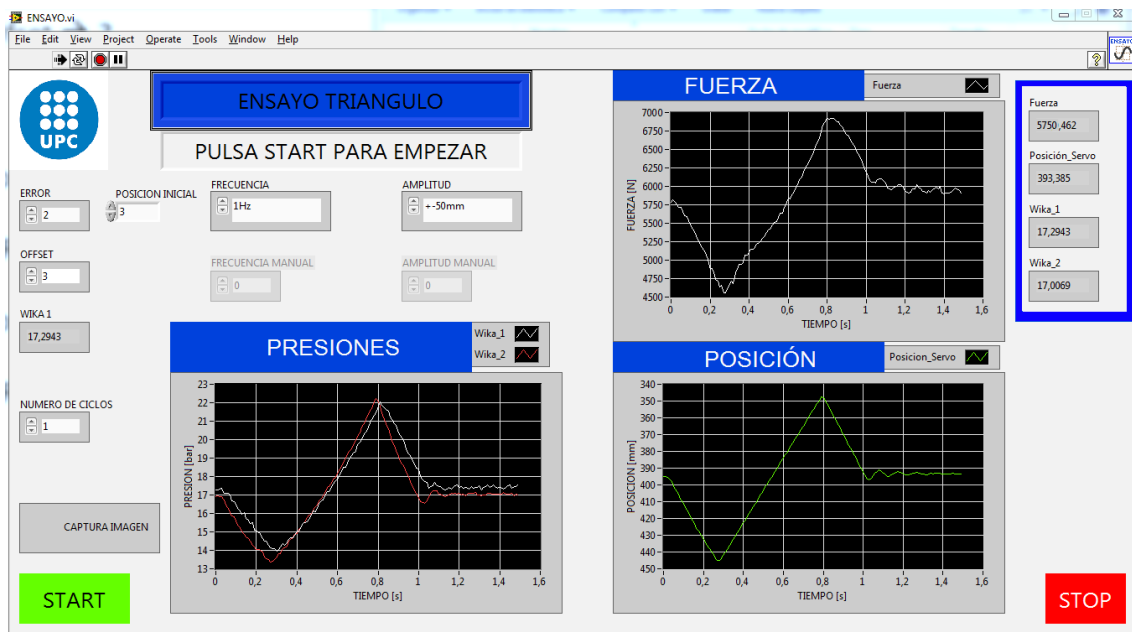
Figura 5.7: Imagen del software (LabVIEW), utilizado para la realización de los ensayos en ciclo triangular para una frecuencia de 1 Hz, a una velocidad de compresión de 186.858 mm/s y carrera de 100 mm.
