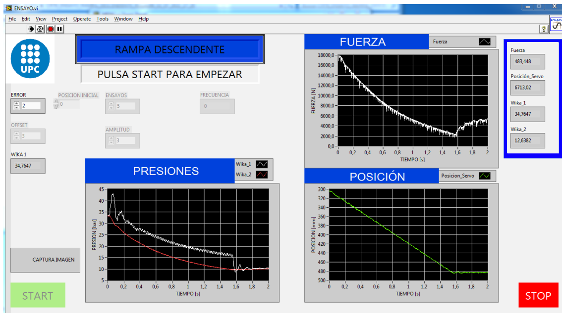
Figura 6.4: Imagen del software (LabVIEW), utilizado para la realización de los ensayos en rampa descendente para una frecuencia de 0.32 Hz, a una velocidad de compresión de 151.26 mm/s y carrera de 240 mm.
