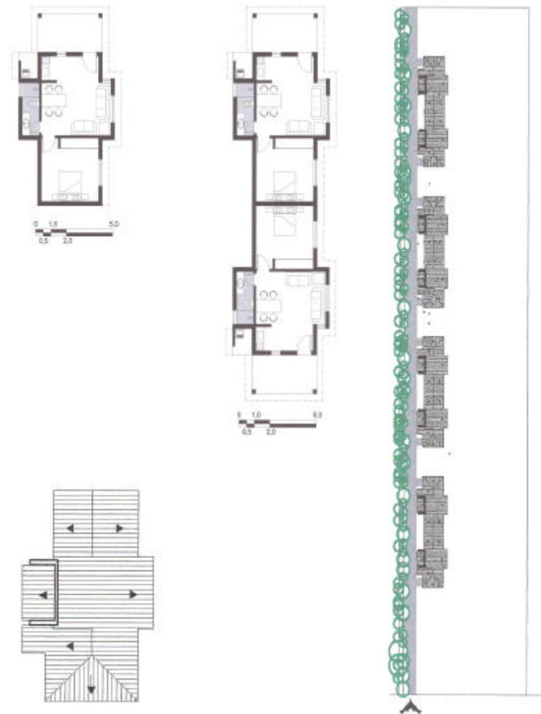
Figura 121 – Posada Vila D'água. Planta baja, forma de acoplamiento, cubierta y emplazamiento. (Diseño Paulo Edi)
