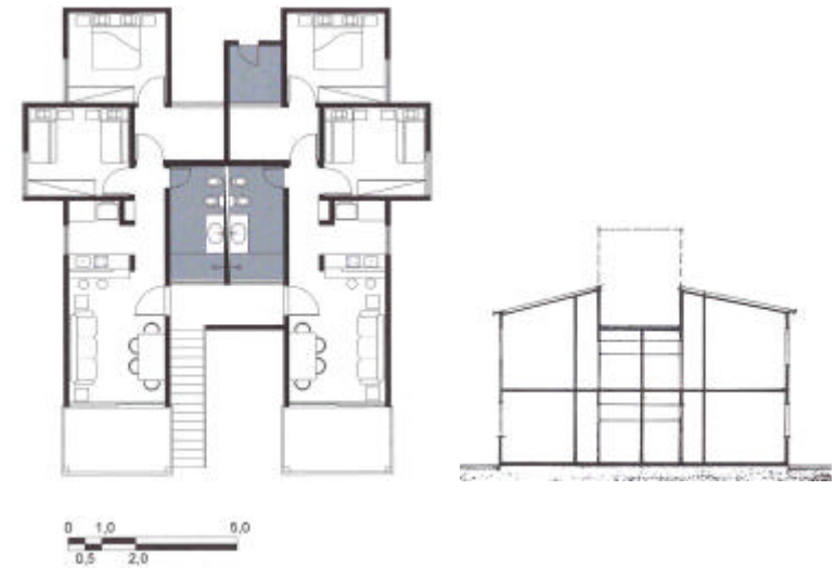
Figura 252 - Planta rebatida con dos dormitorios y Sección transversal. Diseño Paulo Edi. F, Desenho Alternativo )
