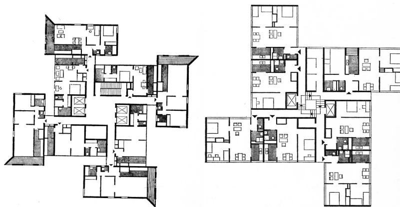
Figura 274 – Plantas en Cruz o Molinillo. (F.: STING, Hellmuth. Plantas de bloques de viviendas . Barcelona: G.Gilli, 1973. p. 27).
